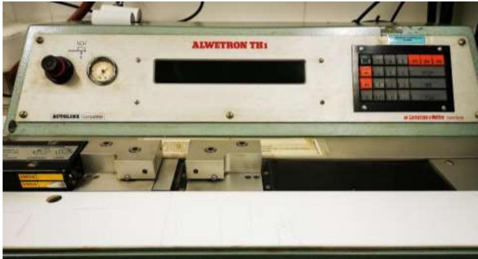
**Figura C. 5** Dinamómetro Alwetron TH-1 del Laboratorio de Productos Forestales.
