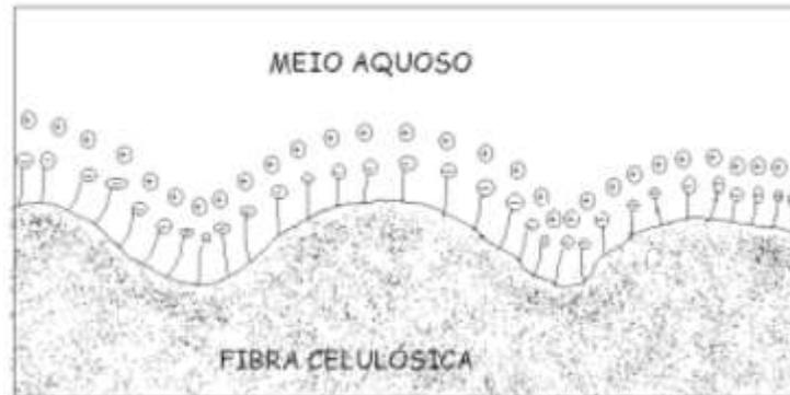
**Figura 9** Ilustración del modelo de Pelton (Fardim, 2002).
