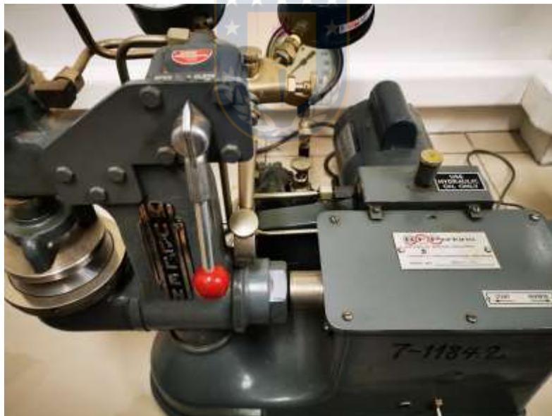
**Figura C. 6** BF Perkins/Mullen Hydrostatic Tester del Laboratorio de Productos Forestales.
