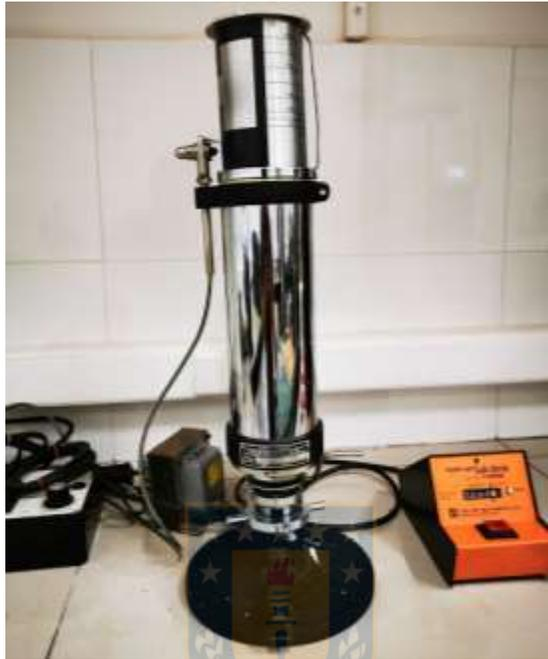
**Figura C.4** Gurley 4190 S-P-S Tester Softness Porosity del Laboratorio de Productos Forestales.
