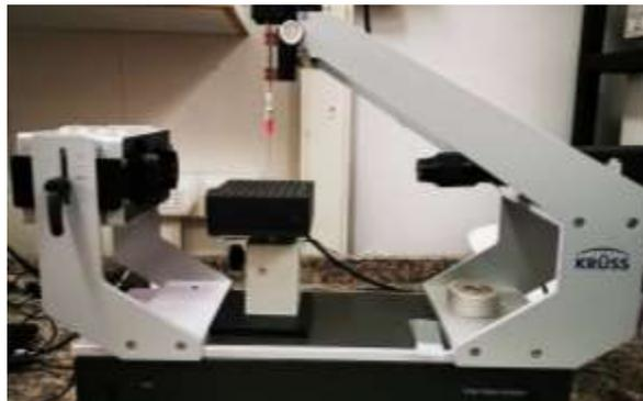
**Figura C. 3** Equipo Drop Shape Analyzer - DSA25 – KRÜSS GmbH del Laboratorio de Materiales Híbridos y Polímeros del DIMAT.
