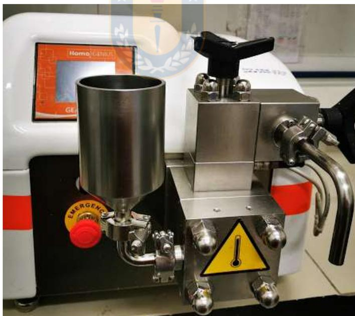
**Figura 28** Homogeneizador GEA PandaPlus 2000 del Laboratorio de Productos Forestales
