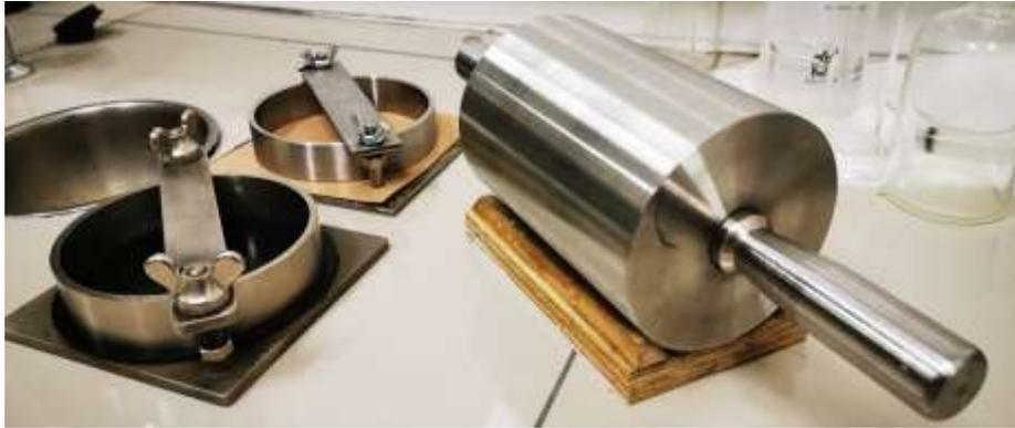
**Figura C. 2** Instrumentos de medición para los ensayos Cobb del Laboratorio de Productos Forestales.
