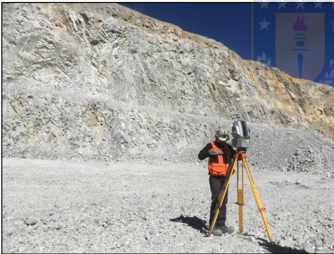
Fotografía 3.2: Láser I - Site 8.800. El dispositivo de detección utilizado para este estudio fue el Láser I - Site de Maptek , que incorpora para su funcionamiento la tecnología LiDAR.
