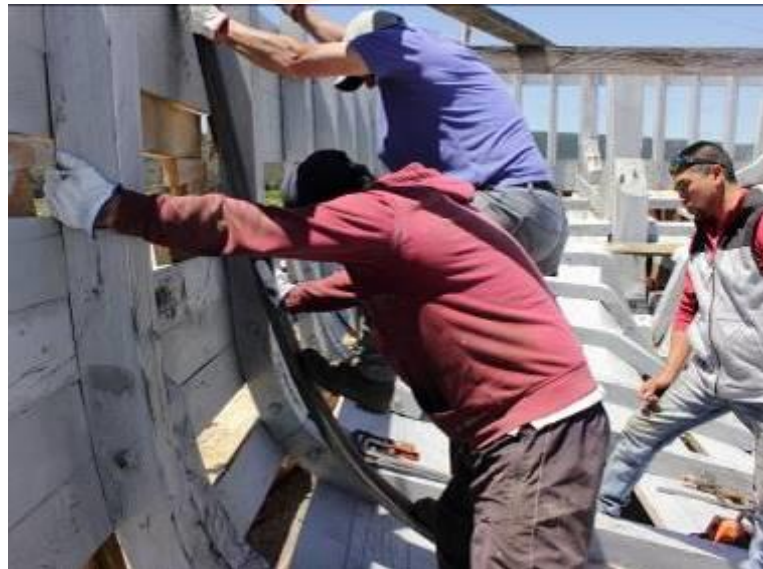
Fig. 3 cuadrilla de carpinteros entablado embarcación, Lebu, 2018.
