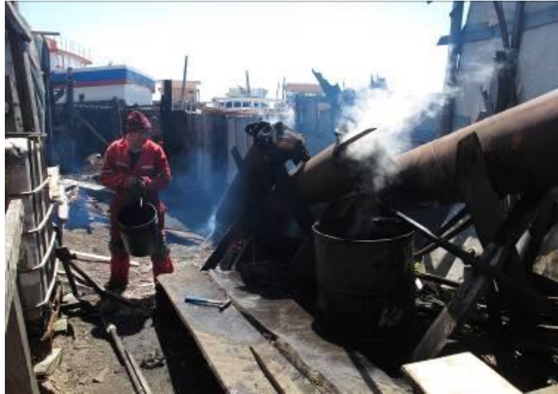
Fig. 8 Maestro carpintero cociendo madera para curvado, Lebu, 2017
