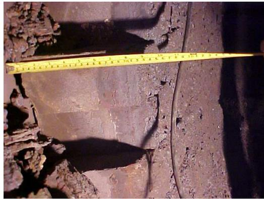
Figura IV.12.8. Medición directa del desgaste de la pared del convertidor.
