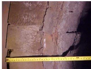
Figura IV.12.9. Medición directa del desgaste de la pared del convertidor.
