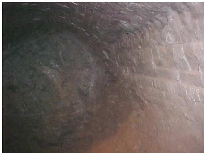
**Figura B.2.** Vista interna del convertidor de la zona opuesta a la línea de toberas
