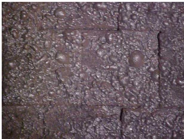
Figura IV.13.2. Vista de la superficie corroída del interior del convertidor PS
