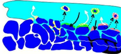
Figura III.8.1. Mecanismos de disolución e infiltración en el refractario poroso
