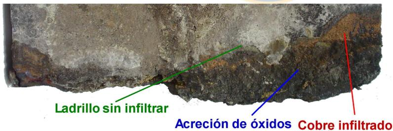
[Figura IV.12.11.](#) Vista de un ladrillo refractario en la zona de las toberas
