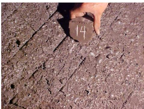
Figura IV.13.3. Vista interior del refractario atacado del convertidor mostrando la posición de la TC 14, ubicada en la nuca del convertidor.
