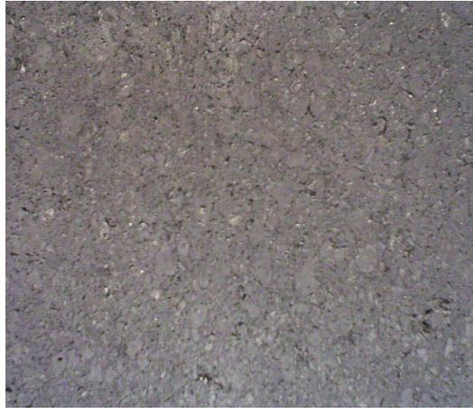
[Figura IV.12.10.](#) Superficie del ladrillo refractario de magnesita – cromita.
