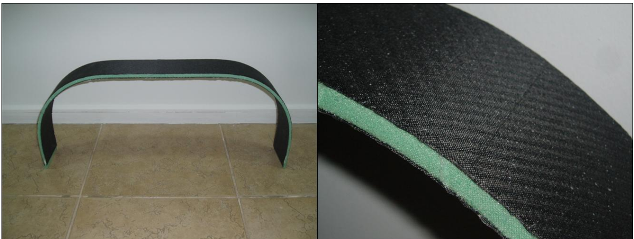
Figura 3.- Prototipo de tren de aterrizaje fabricado por infusión al vacío [14].
