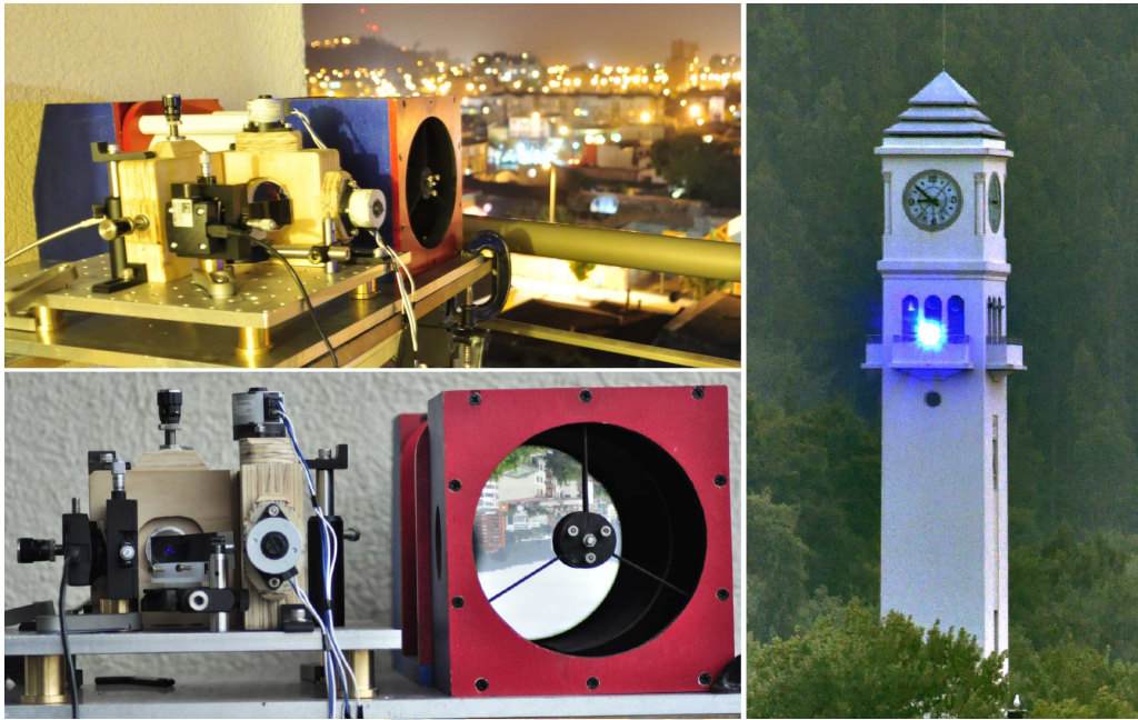
Figura 4.12: Esquema de medición con DOAS en configuración biestática con dispositivo de óptica activa para mediciones prolongadas en el tiempo. El telescopio emisor está ubicado en la parte alta de la torre del Campanil en la Universidad de Concepción, mientras que el telescopio receptor junto con el módulo de óptica adaptativa más el espectrómetro yacen en la terraza del octavo piso del edificio Concepto & Estilo ( 36^{\circ}49'19,12''S 73^{\circ}02'37,71''O ), acumulando 938\text{ m} de trayecto óptico entre ambas estaciones.
