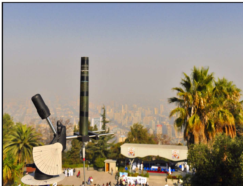
Figura 3.27: DOAS pasivo transportable, instalado sobre el Cerro San Cristóbal en Santiago de Chile, en día de preemergencia ambiental del 14 Mayo del 2011. El sistema de DOAS pasivo se constituye de: tubo oscuro 1° FOV, fibra óptica para UV, espectrómetro Ocean Optics HR-4000, computador y trípode.
