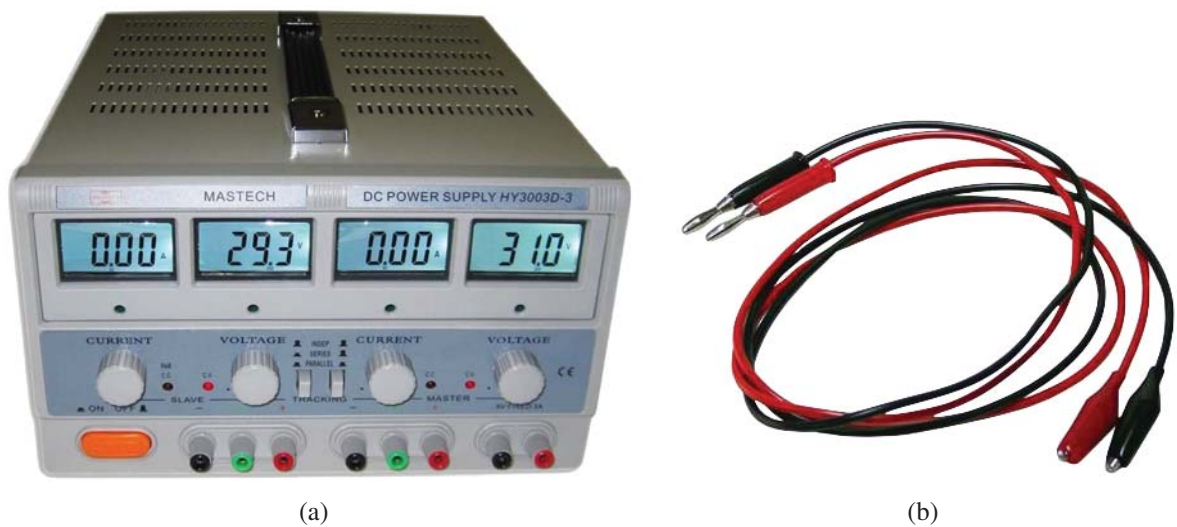
Figura 4.16: (a) Fuente MASTECH DC POWER SUPPLY HY3003D-2, y (b) Cables de poder Banana-Caimán.
