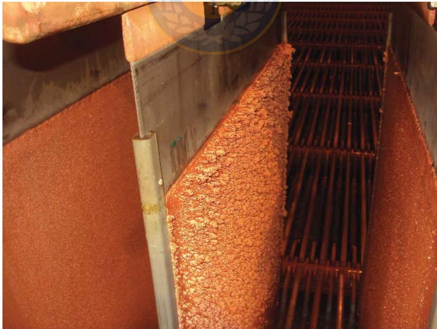
**Fig. 2.9:** Nodulación producida por un circuitos abierto en un ánodo.
