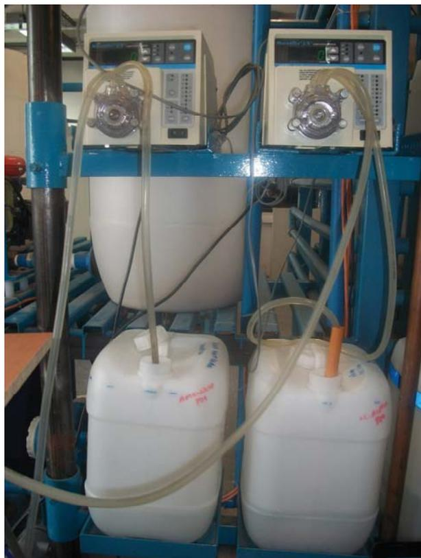
Fig. D.2 Estanques de Ácido Acético y Amoniaco, y Bombas Masterflex 7550.
