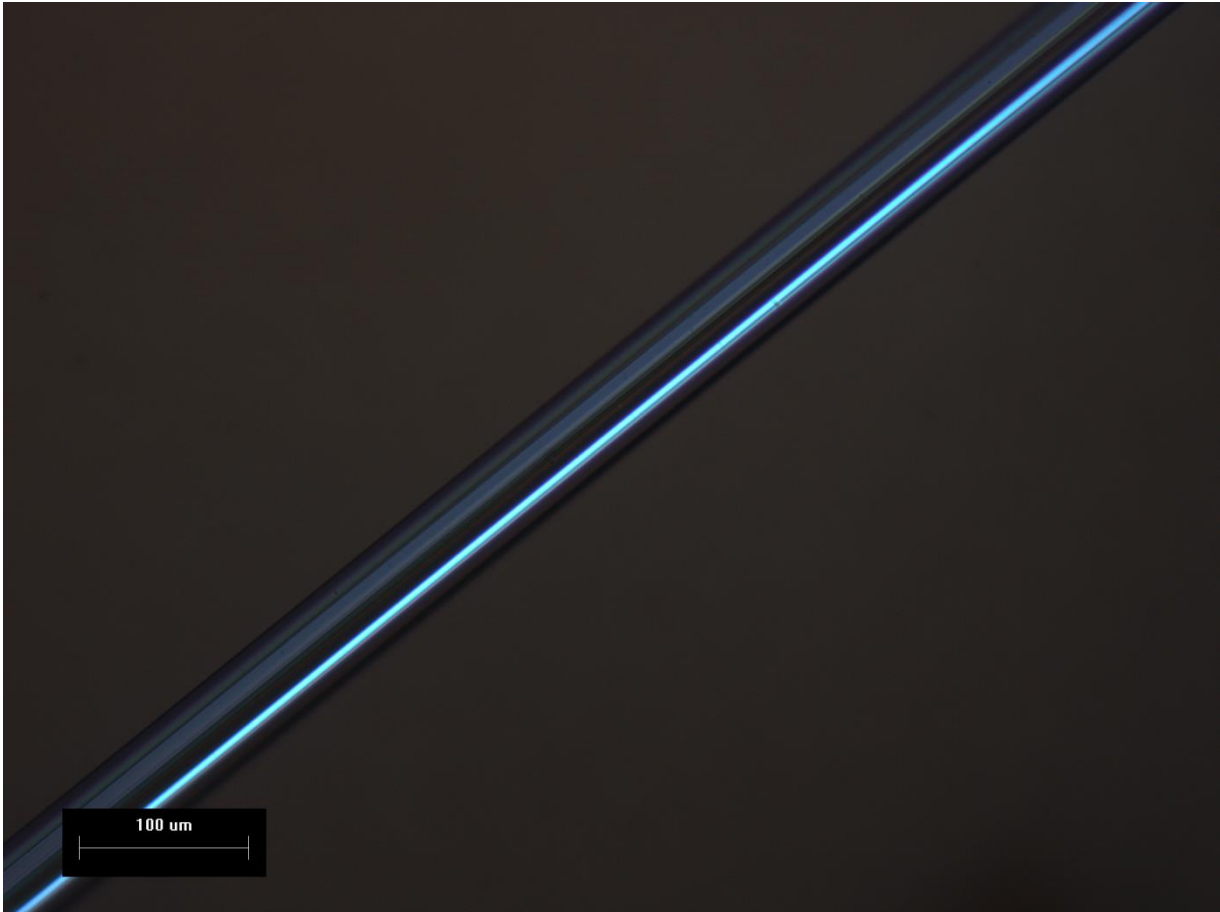
Figura 23. Microfotografía mediante POM de fibra fabricada a partir del compuesto 9b10 .
