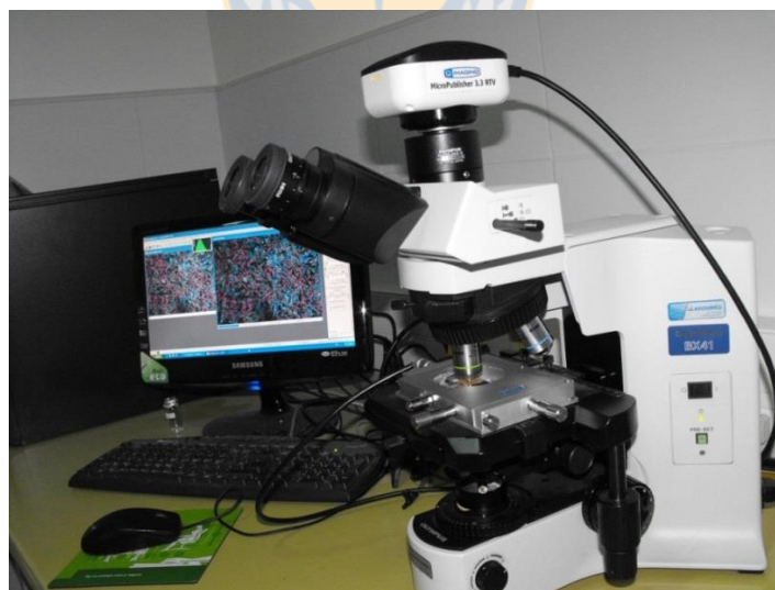
Figura 15. Montaje experimental para observación de muestras mediante microscopio óptico de luz polarizada con portaobjeto de temperatura variable.
