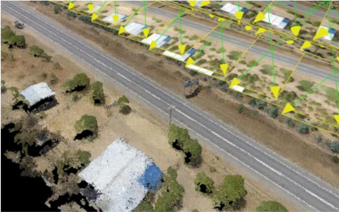
Figura 3.2: DSM del proceso fotogramétrico
