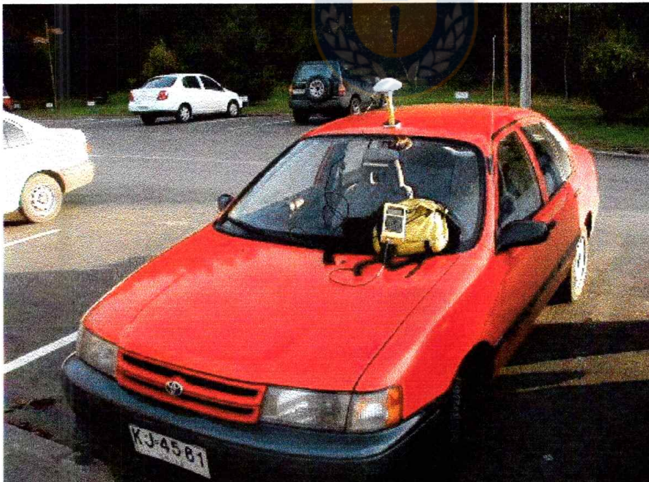
Figura 11. Levantamiento con GPS en vehículo.
