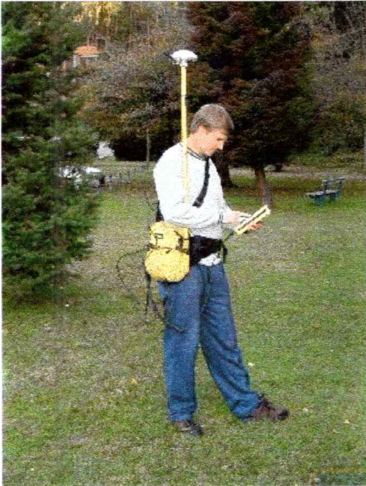
Figura 10. Levantamiento con GPS a pie.
