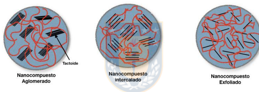
Figura. 5. Morfología de nanocompuestos poliméricos-arcilla.
