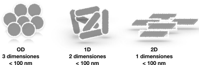
Figura. 3. Clasificación de los materiales nanoestructurados según sus dimensiones.
