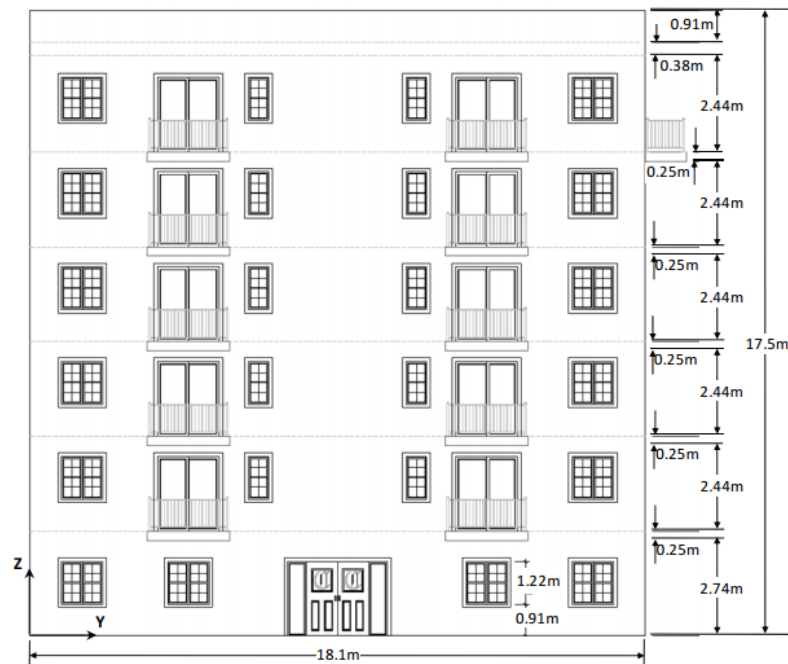
Figura 3.5 Vista en elevación de la cara sur del edificio NEESWood (Pang et al., 2010)
