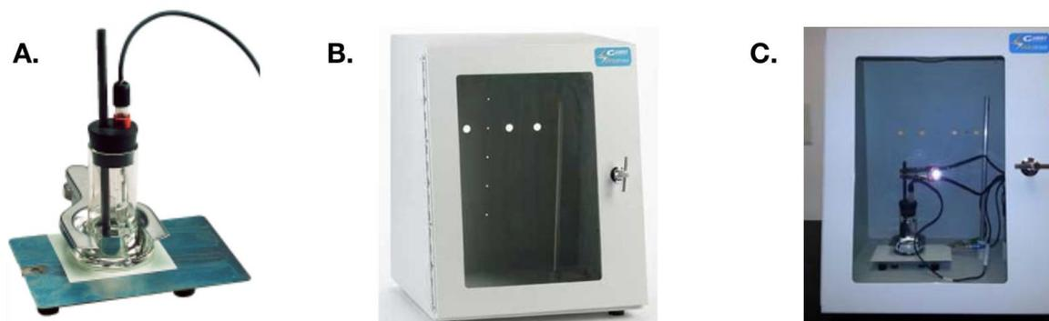
Figura 14 A. Montaje celda electroquímica para evaluación de recubrimientos B. Jaula de Faraday C. Montaje técnica electroquímica para pinturas Fuente: Elaboración propia
