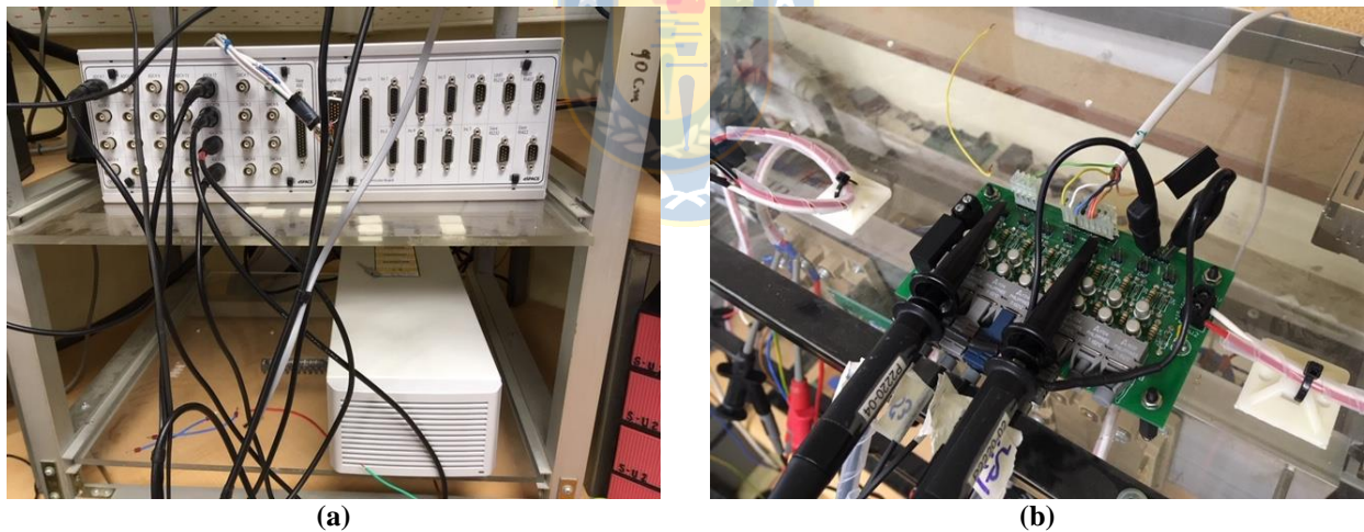
Fig. 4.4 Equipos para la implementación de sistemas de control. (a) Módulo dSPACE DS1103, (b) Circuito de adquisición señales desde dSPACE. Fuente: Elaboración propia.
