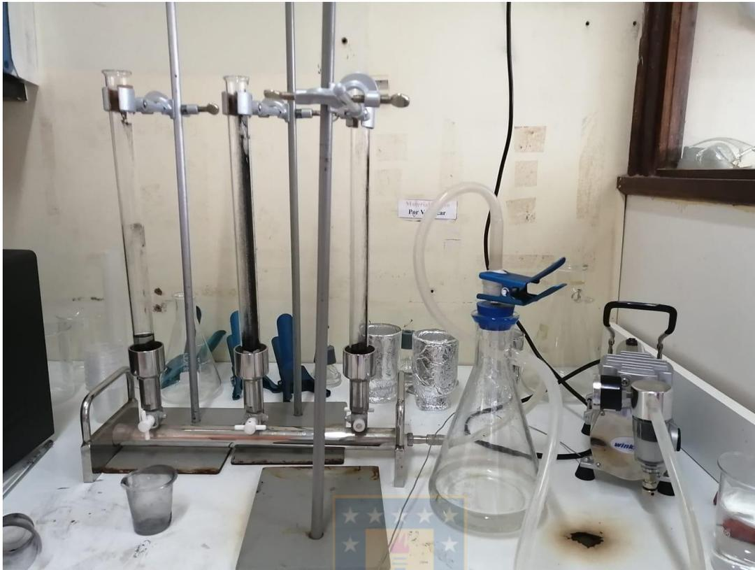
Figura N°4: Sistema de filtración por columnas de carbón activo en serie.
