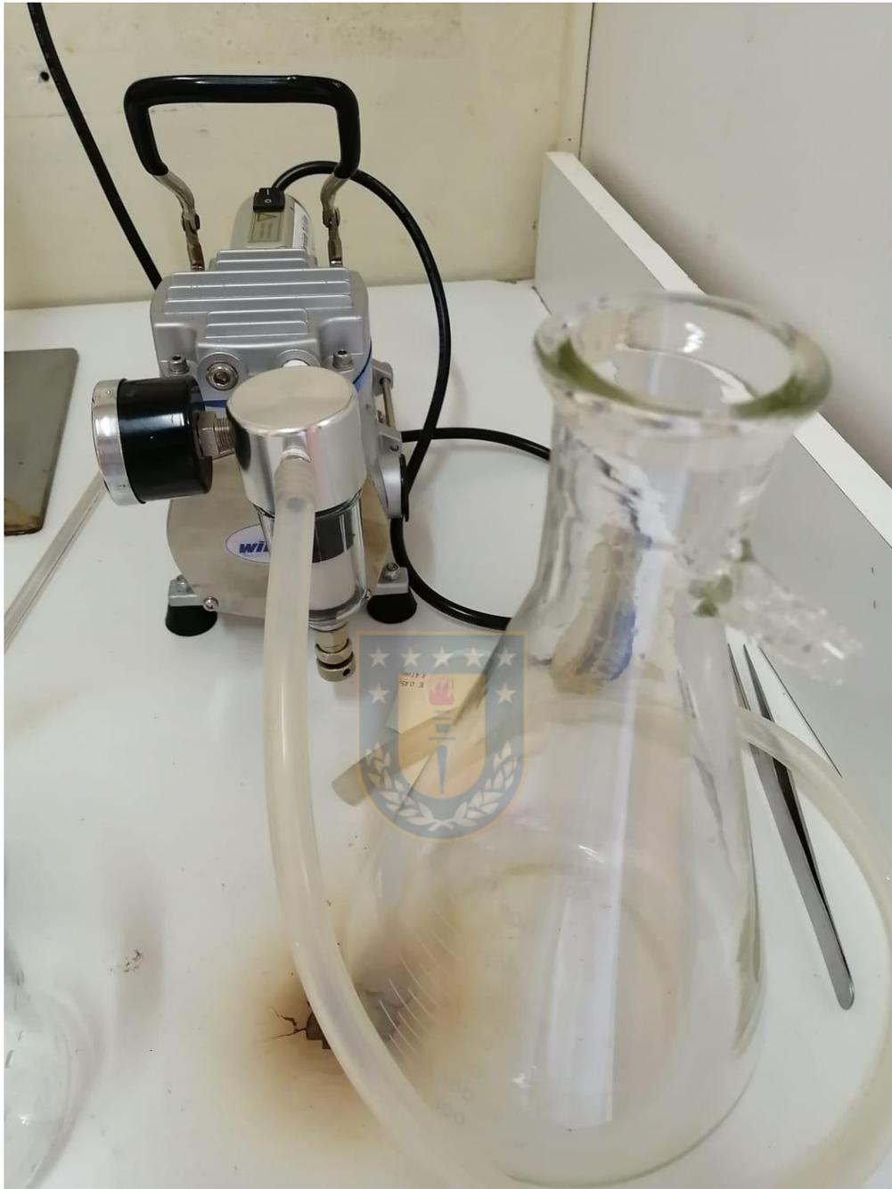
Figura N°5: Filtración por membranas de celulosa.
