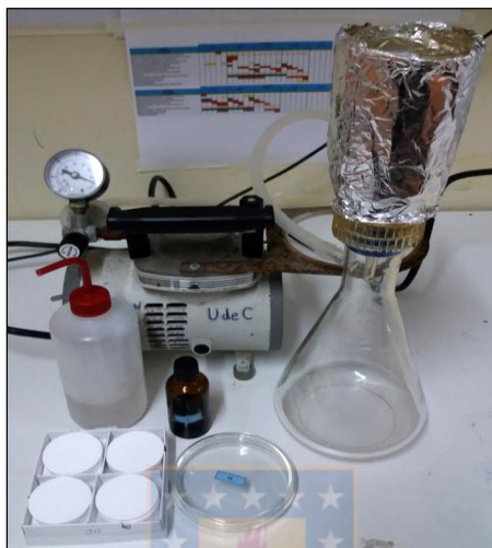
Figura 7. Materiales usados en el proceso de filtración.
