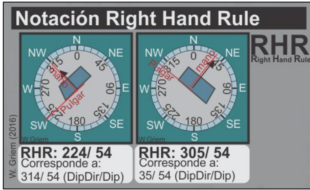
Figura 1.10: Representación en notación RHR de diferentes elementos planares, junto con su equivalencia a la notación DD/D, Griem (2016).
