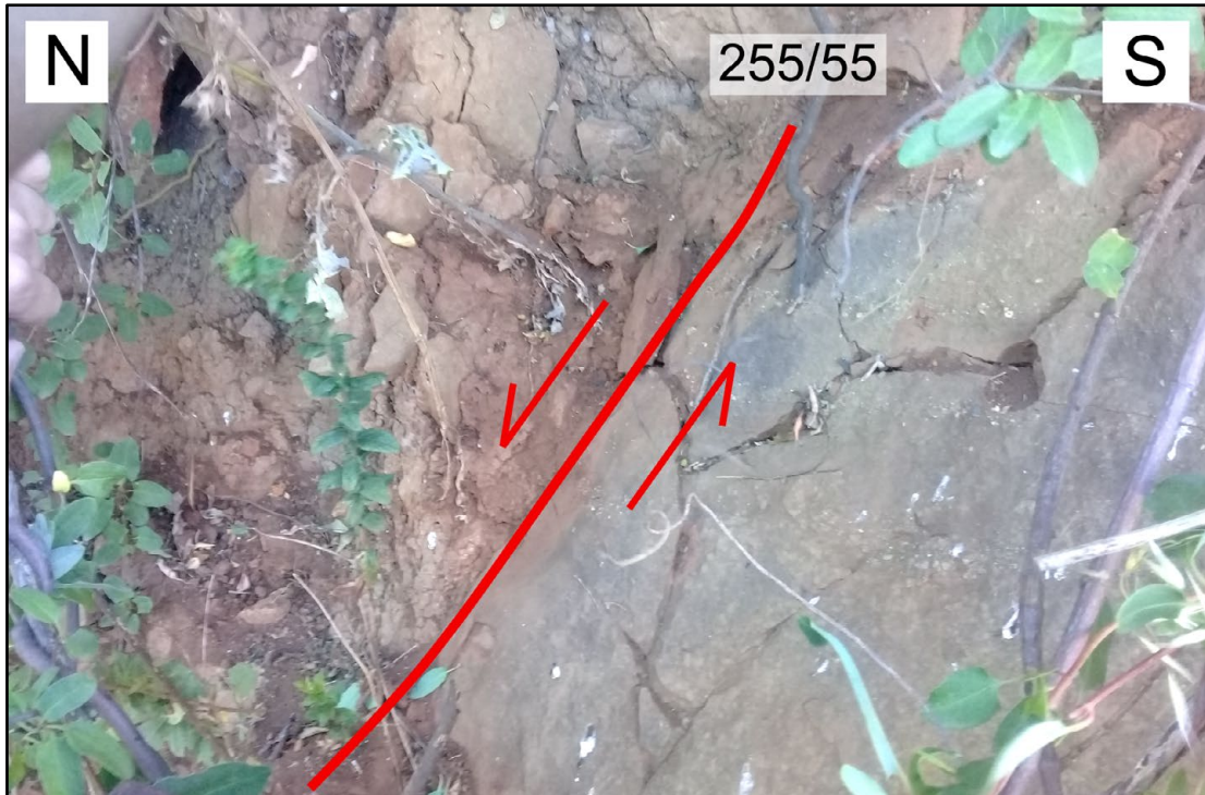
Figura 4.48: Plano de falla en el extremo N del afloramiento PER – 4. Al costado septentrional se distingue la zona de daño estructural.
