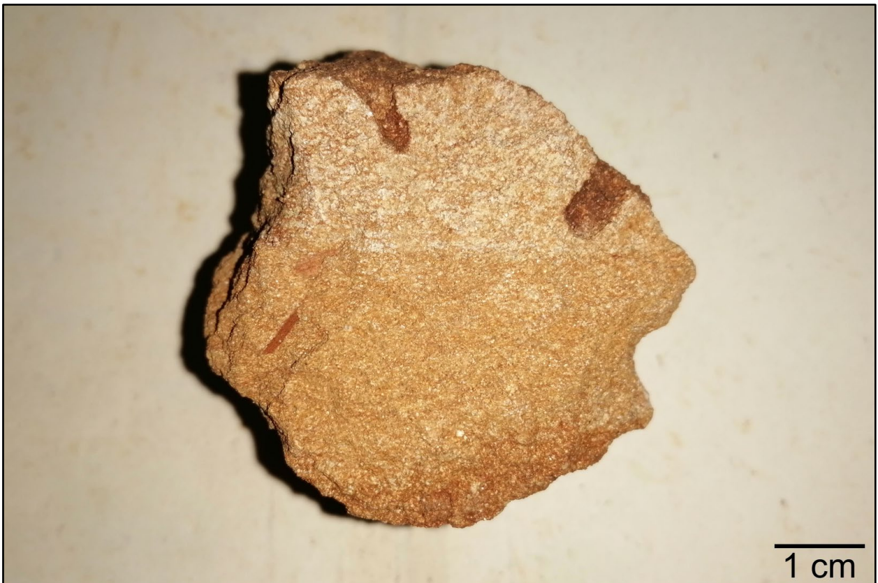
Muestra LAU - 9.1: Contacto entre arenisca de grano fino (abajo) y arenisca de grano medio (arriba).
