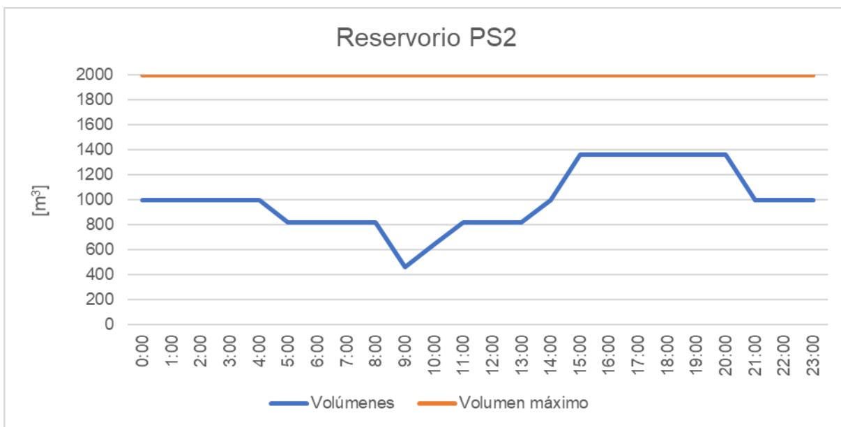
Figura 20. Volúmenes de agua horarios en el reservorio de la unidad PS2 (mes de diciembre).
