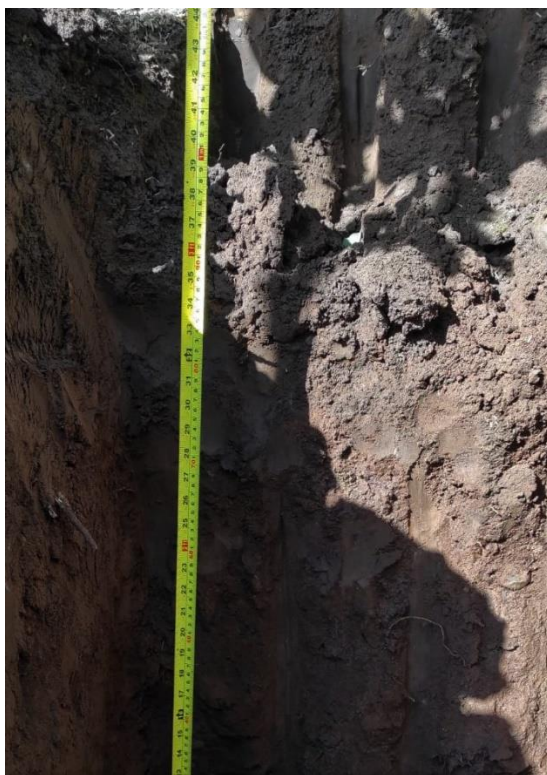
Figura 5A. Calicata realizada en el sector C2.
