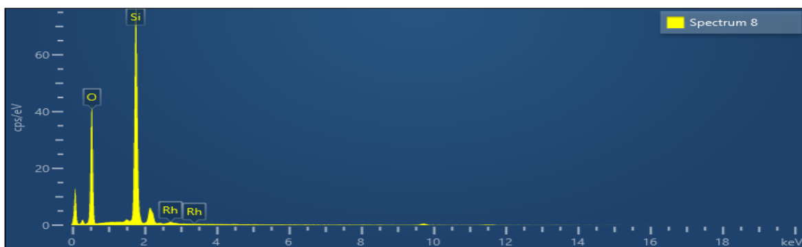
Figura 19. Análisis SEM-EDS para el catalizador Rh/SiO 2 .
