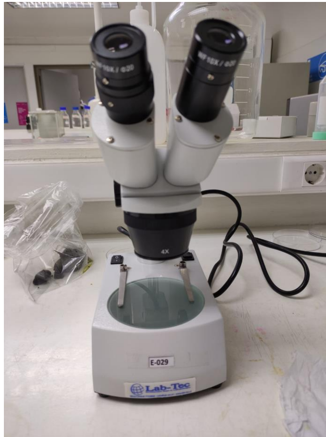
Figura 4. Lupa estereoscópica utilizada en la identificación taxonómica.
