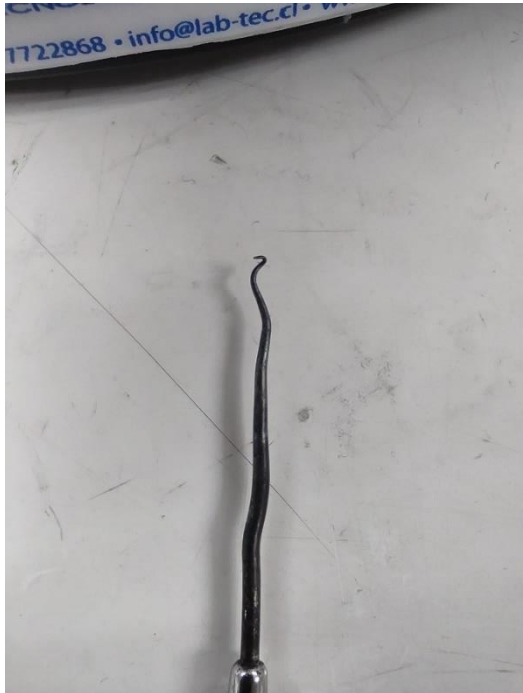
Figura 8. "Punta" utilizada para manipular la muestra bajo lupa.
