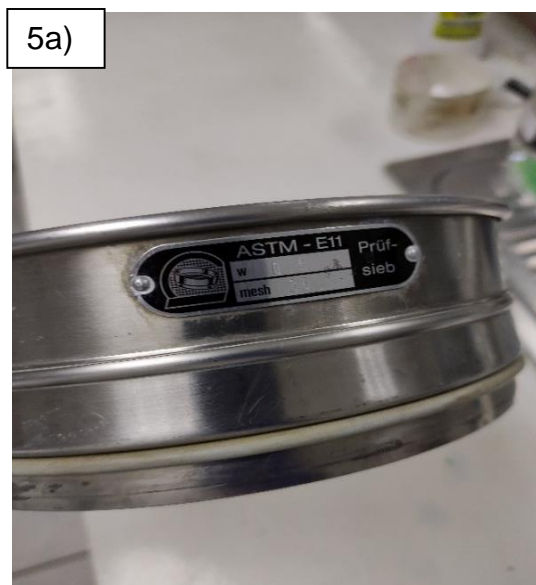
Figura 5. Tamiz de 500 \mu\text{m} utilizado para quitar el alcohol de la muestra en el laboratorio a) Vista lateral b) Vista superior.
