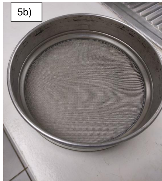
Figura 5. Tamiz de 500 \mu\text{m} utilizado para quitar el alcohol de la muestra en el laboratorio a) Vista lateral b) Vista superior.
