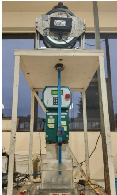
Figura 10. Visor de burbuja en su estructura, junto a la celda mecánica EDEMET (Fuente: Elaboración propia).
