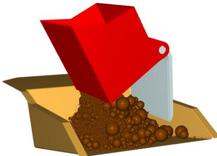
Figura 6.1 Captura de pantalla de la simulación de la carga por medio de una pala en un t=16.3s mostrando una vista posterior del proceso. La cantidad de partículas corresponden al segundo vertido de material.
