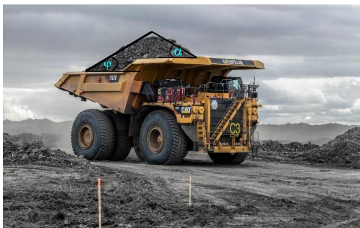
Figura 5.6. Ángulo de reposo del mineral en faena.
