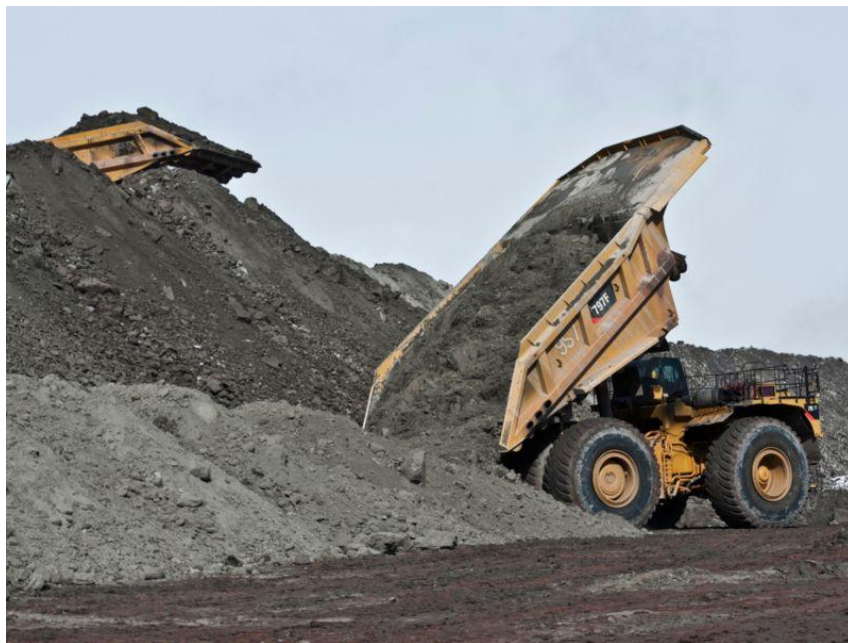
Figura 2.6. Camión CAT 797F descargando mineral con la tolva elevada a 45°.
