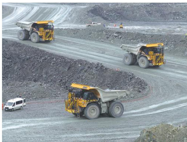
Figura 2.5. (a) Transporte de mineral por el camión CAT 797F hacia la zona de descarga. (b) Regreso del camión CAT 797F vacío al punto de carga.
