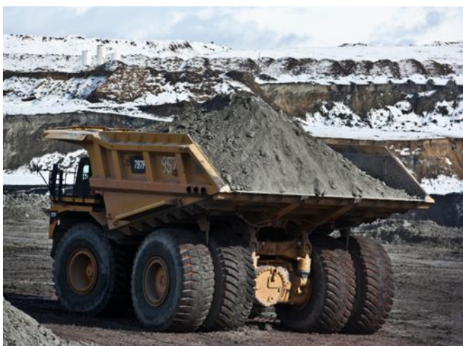
Figura 2.5. (a) Transporte de mineral por el camión CAT 797F hacia la zona de descarga. (b) Regreso del camión CAT 797F vacío al punto de carga.
