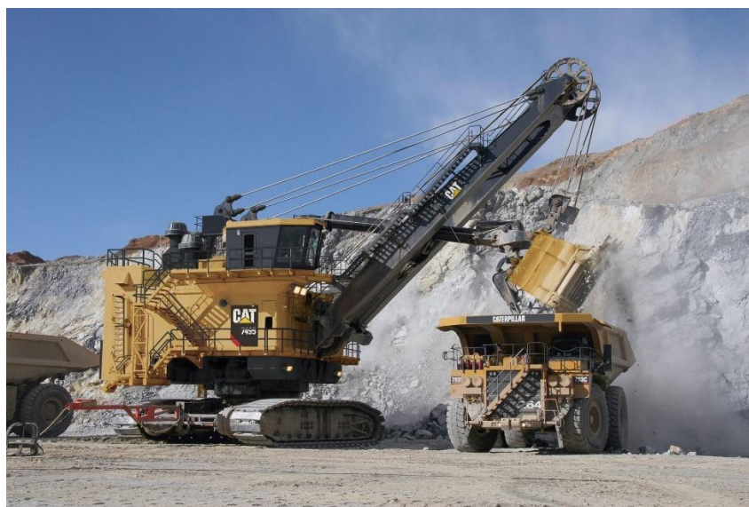
Figura 2.4. Pala de cable Bucyrus 495 HR2 cargando mineral a camión CAT 793C.
