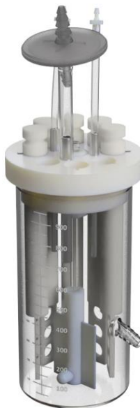
Figura 1. Biorreactor de biopelícula CDC (CBR). Fuente: CDC Biofilm Reactor (CBR) Operator's manual
