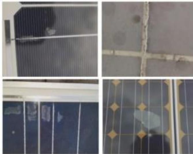
Figura 7. Evidencia visual de la delaminación celular en paneles fotovoltaicos.
