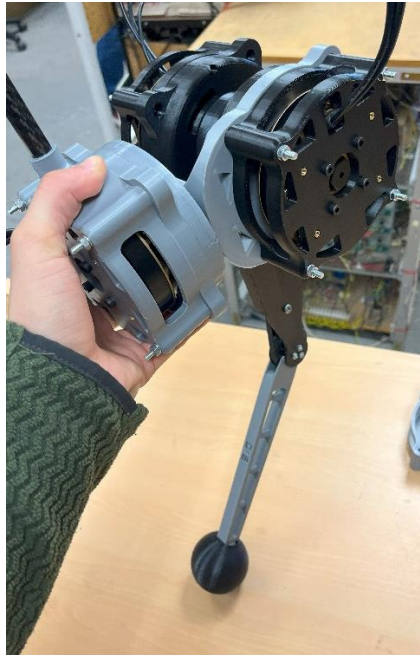
Figura 5.5: Pierna completa de robot B1P0 de 3 grados de libertad
