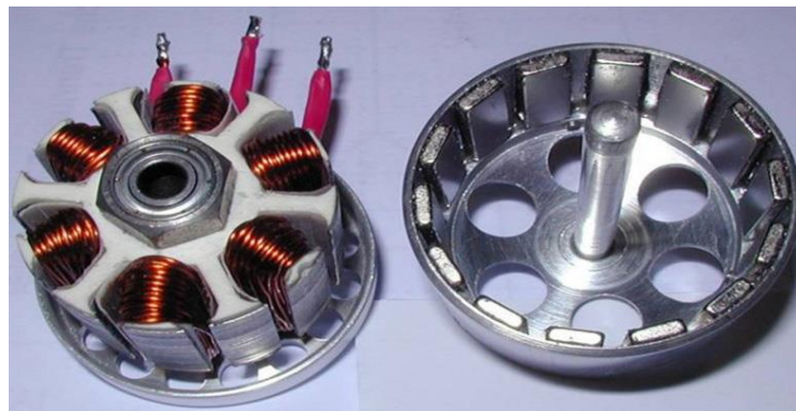
Figura 2.2: Estructura interna de un motor BLDC de tipo Outrunner
