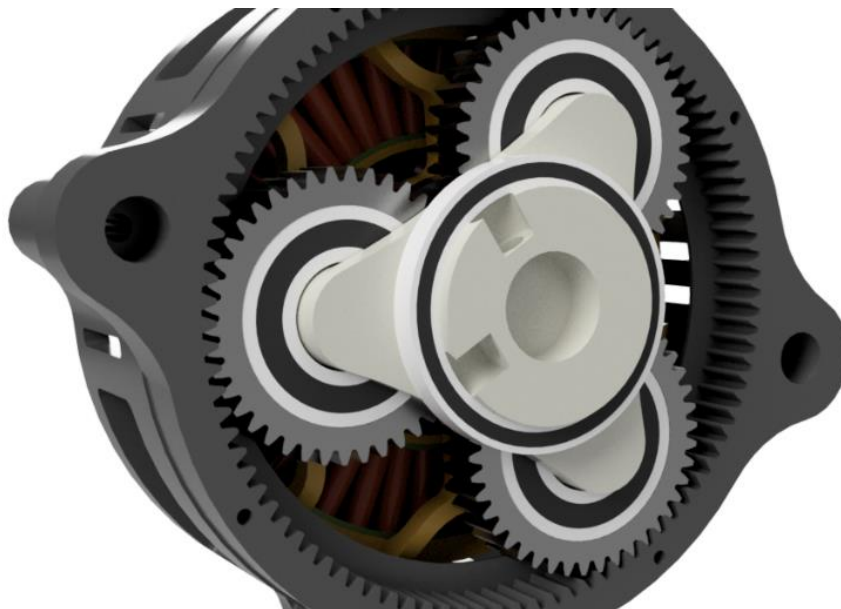
Figura 4.1: Tren de engranajes planetarios con porta planeta y rodamientos
