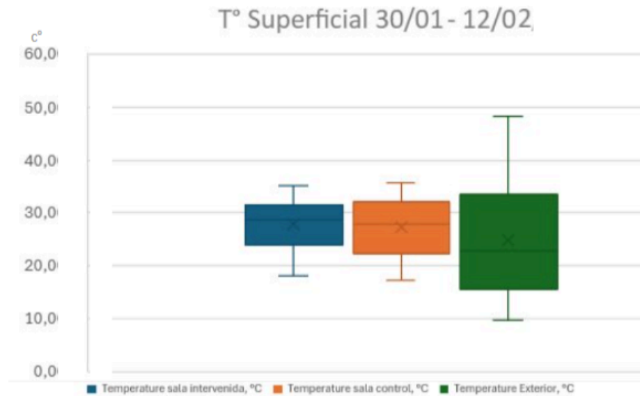
(Gráfico.3.- RH% Sala 5 y 7. Fuente: Elaboración propia en base a medición sensor MX1104 de Sala 5-Sala 7) Gráfico resumen de T° superficial de muro exterior, muro interior sala intervenida y muro interior sala de control. 30 de enero del 2025 hasta el 12 de febrero del 2025
