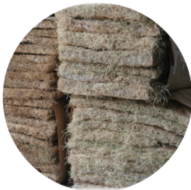
(Fig.11.- Aislante hecho en base a raíces de avena. Fuente: Rootman- https://www.rootman.com/que-hacemos/ )
