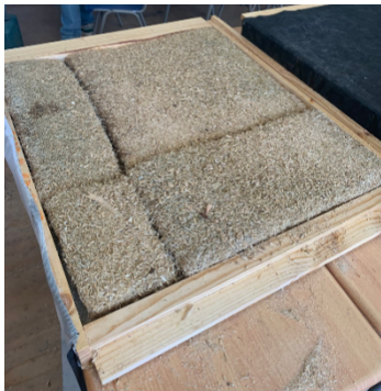
(Fig.29.- Interior de paneles con el eco aislante hecho en base a raíces de avena.Fuente: Archivos personales)
