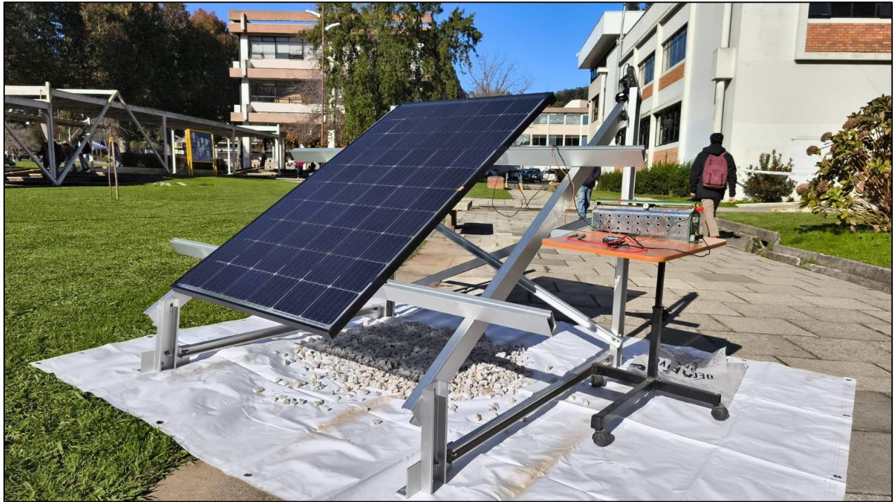
Figura 4.1: Setup de panel instalado sobre cuarzo blanco.
