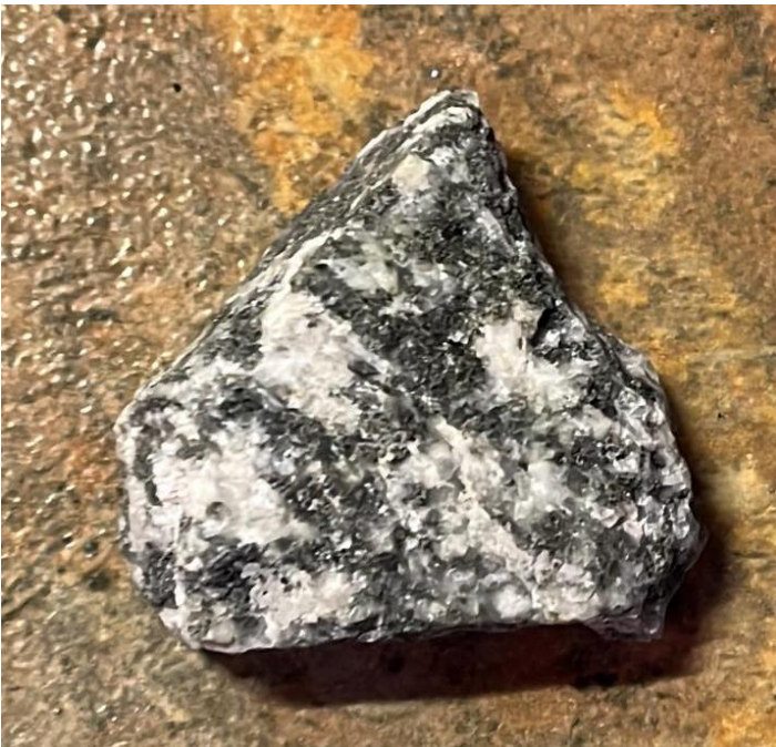
Figura 33. Muestra de tonalita obtenida a partir de la perforación del pozo 1 en el sector Termas de Ralún.
