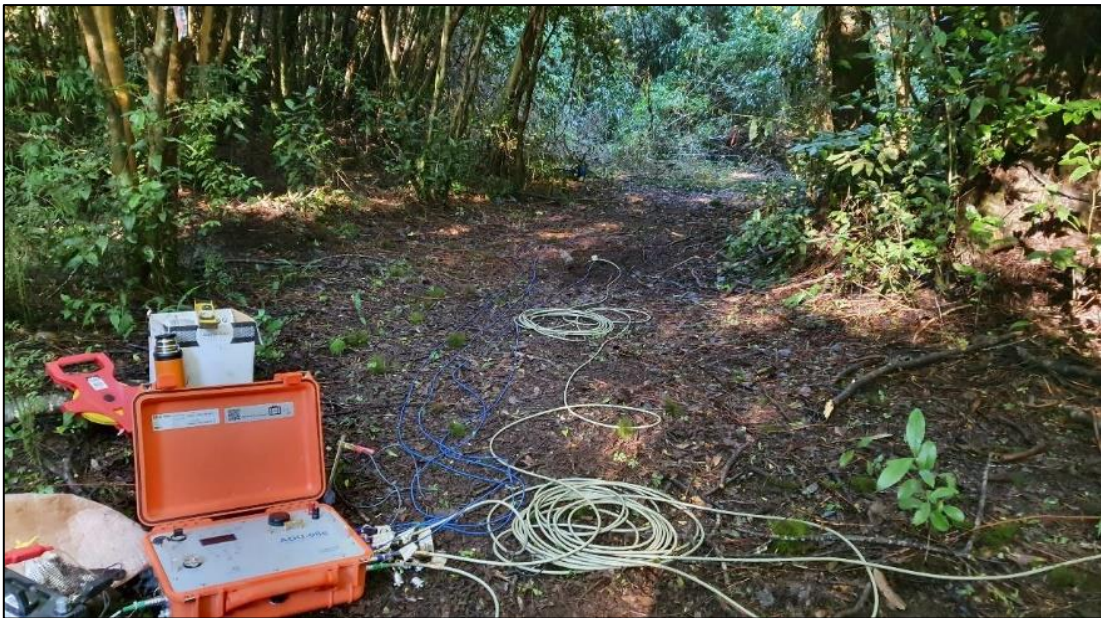
Figura 9. Equipos de adquisición ADU08e utilizados en la campaña magnetotélúrica en el sector de estudio. Fotografía proporcionada por GeoResource.
