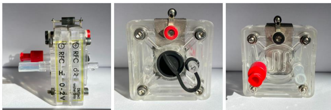
Figura 7. Vista de los distintos lados del electrolizador, mostrando su estructura y conexiones.
