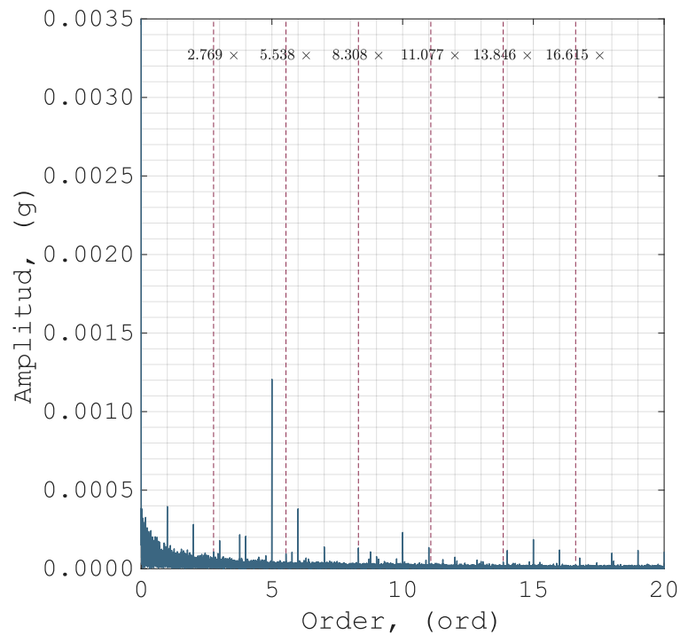
Figura 7.6: Transmisión planetaria sin falla (1200 rpm, 45 Nm). Acercamiento a los ordenes bajos.
