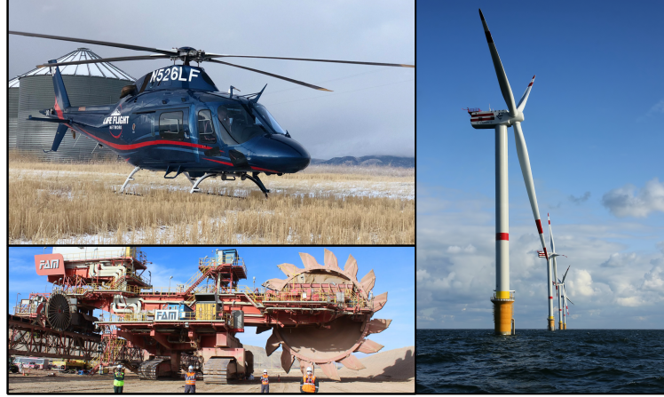
Figura 4.2: Aplicaciones de las transmisiones planetarias [19]
