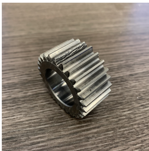
Figura 6.3: Daño generado artificialmente en uno de los planetas
