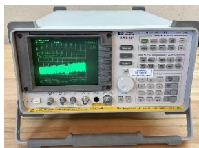
Figura 7.1 & 7.2: Analizador de Espectros, Hewlett Packard (HP) 8565E
