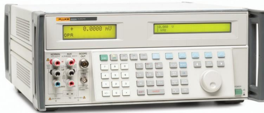
Figura 8.1: Calibrador Multiproducto (MPC), Fluke 5522A (Patrón)
