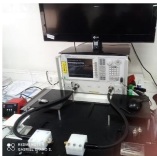
Figura 1.1, 1.2 & 1.3: Pantalla y Analizador de Redes Vectoriales, Agilent N5230C
