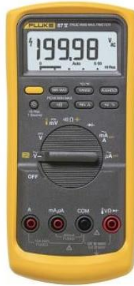
Figura 9.1: Multímetro Digital (DMM), Fluke 87V (UUT)
