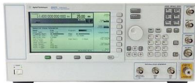
Figura 6.1 & 6.2: Generador de Frecuencia, Agilent E8257D
