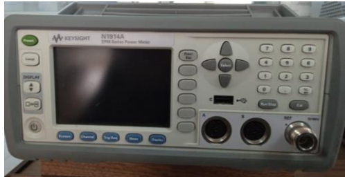
Figura 2.1 & 2.2: Medidor de Potencia, Keysight N1914A
