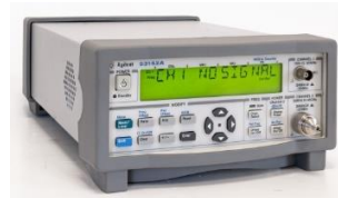
Figura 5.1 & 5.2: Contador de Frecuencia, Agilent 53152A
