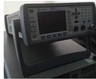
Figura 2.1 & 2.2: Medidor de Potencia, Keysight N1914A
