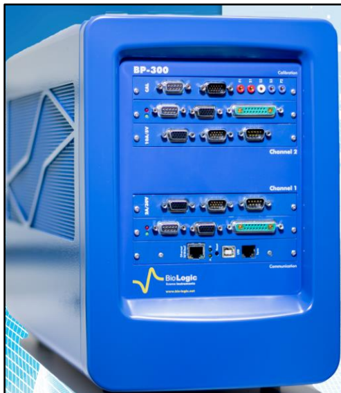
Figura 7.2. Potenciostato BioLogic modelo BP-300 utilizado en la evaluación electroquímica.
