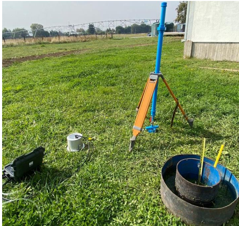
Figura 5. Infiltrómetro SATURO, infiltrómetro de Leite y cilindro doble anilla en prueba de infiltración.
