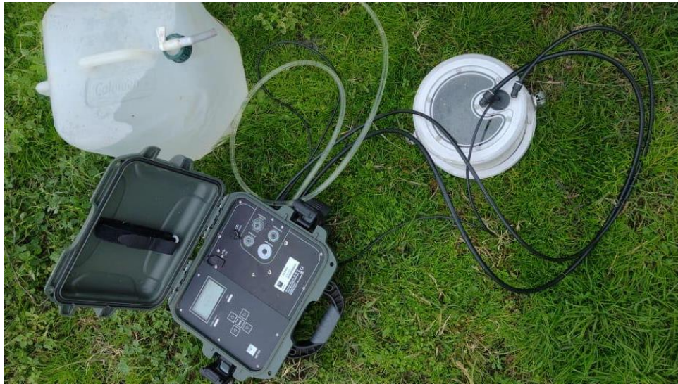
Figura 2. Infiltrómetro SATURO, cámara hermética a la derecha y estanque plástico a la izquierda.
