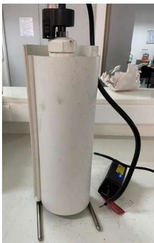
Figura 10. Ilustración montaje experimental de reactor construido para el tratamiento de RIL. (Fuente: Elaboración propia)
