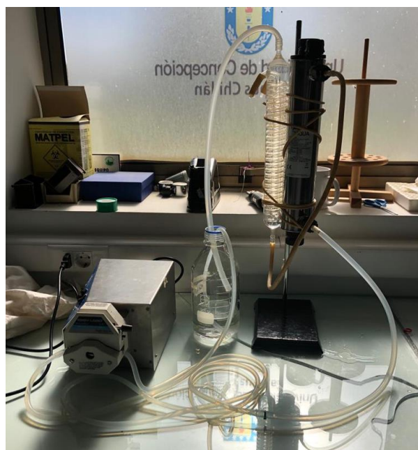
Figura 9. Ilustración montaje experimental de reactor comercial para el tratamiento de RIL. (Fuente: Elaboración propia)
