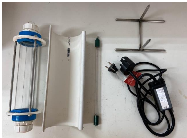
Figura 16. Materiales utilizados para la construcción del reactor local (Fuente: Elaboración propia).
