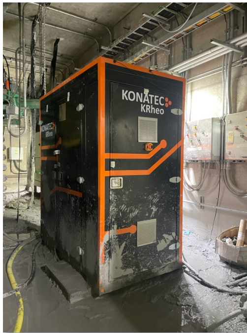
Figura 6. Reómetro en línea 'KRheo' de la empresa Konatec.
