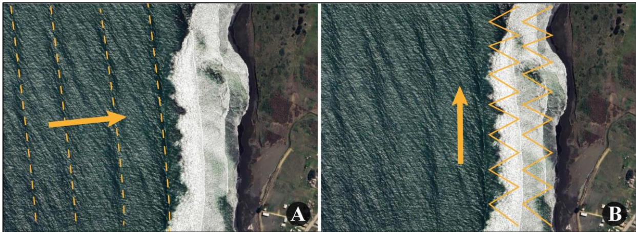
Figura 2.5 Mecanismos de transporte de sedimentos en la zona de playa de Vegas de Itata. Adaptado de Morales et al. (2014). [A] Transporte transversal, con frentes de olas demarcados con línea segmentada, [B] Transporte longitudinal.
