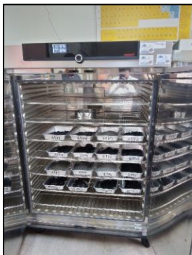
Figura 5.3 Horno eléctrico para el secado de muestras.
