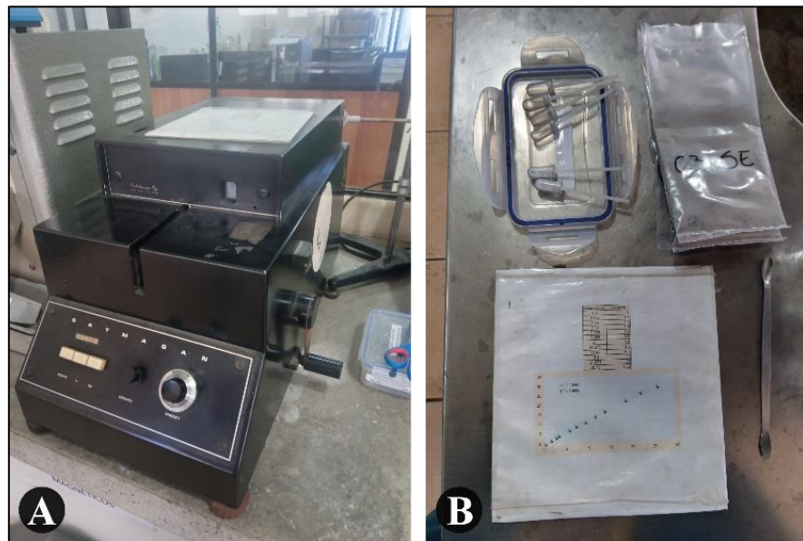
Figura 5.8 Equipo y elementos utilizados para cuantificación de magnetita. [A] SATMAGAN 133, [B] Cápsulas de muestra, pulverizados de arenas y ficha de calibración.
