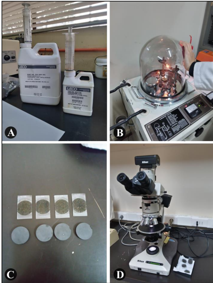
Figura 5.5 Equipos y elementos utilizados en la etapa confección y análisis de cortes pulidos transparentes. [A] Resina y endurecedor aplicados a la solución de las briquetas, [B] Carbonización de briquetas, [C] Pulidos transparentes a partir de briquetas, [D] Microscopio Nikon 275150 donde es realizada la observación óptica de los pulidos transparentes.
