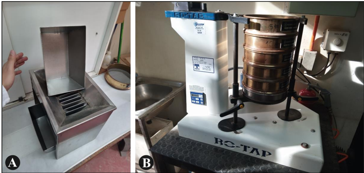
Figura 5.4 Equipos utilizados para el análisis granulométrico. [A] Cuarteador, [B] Tamizador RO-TAP.
