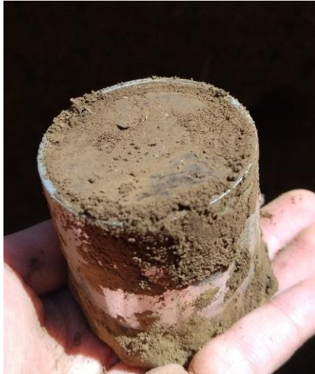
Figura 7. Muestreo de densidad aparente de suelo con cilindro de volumen de 100 \text{ cm}^3 a diferentes profundidades (0-20 cm, 20-40 cm, y 40-100 cm).
