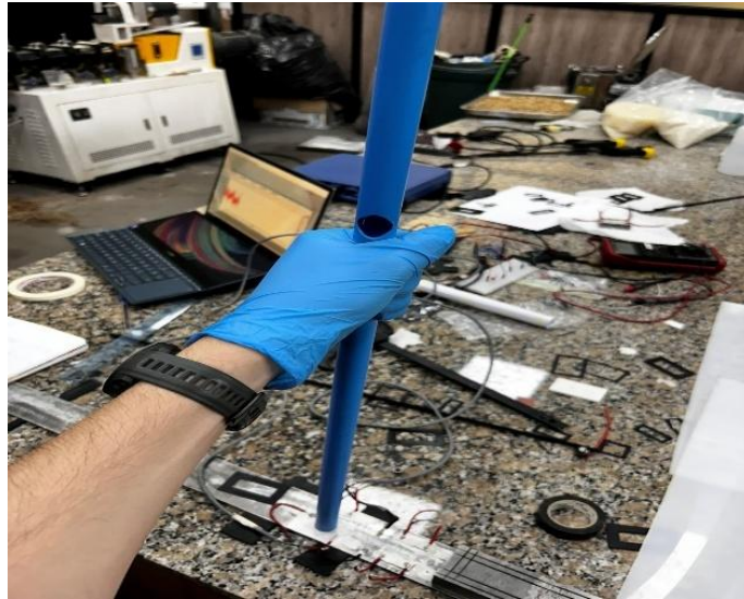
Figura 4.7. Tubo de PVC con agujeros a las alturas señaladas.
