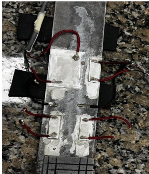
Figura 4.8. Sensores sobre la barra de acero.
