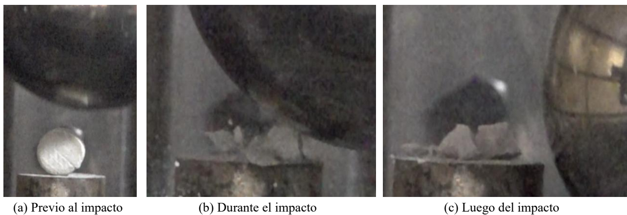
Figura 4.5: Ensayos de fractura probetas de concreto
