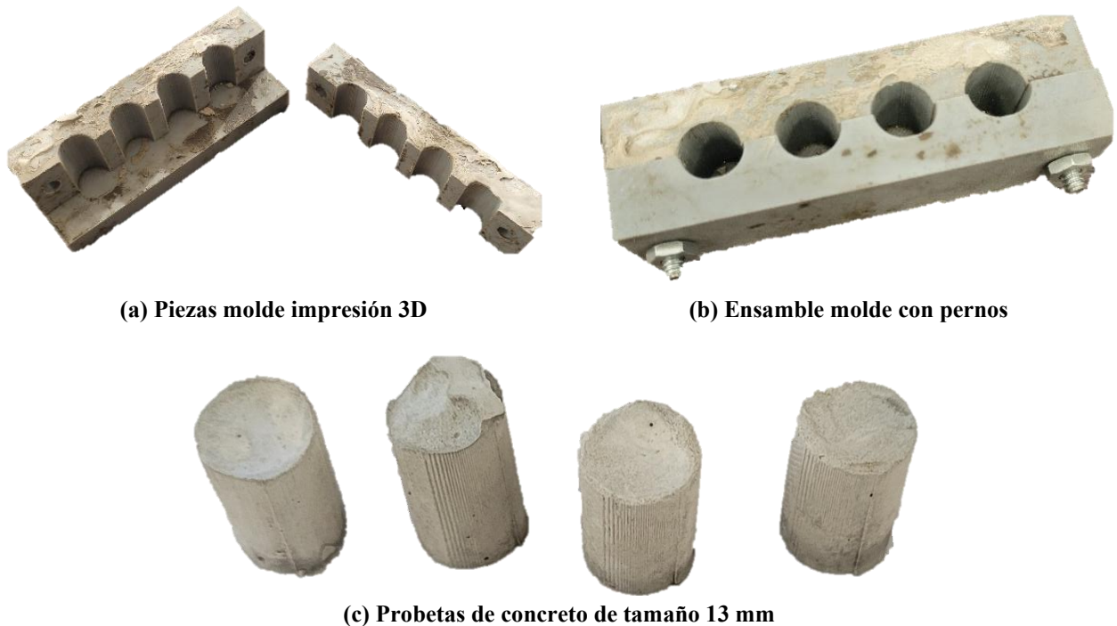
Figura 3.9: Moldes y fabricación probetas de concreto
