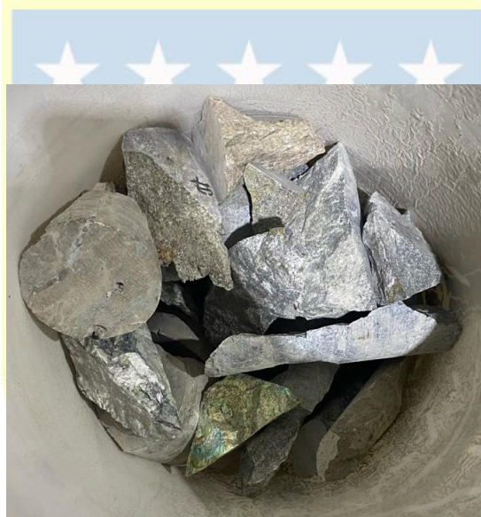
Figura 20. Muestra de mineral obtenida de residuos utilizados en ensayos de compresión uniaxial en Laboratorio de Mecánica de Rocas, DIMET.
