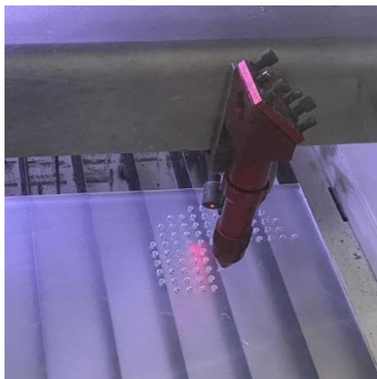
Figura 10. Construcción de tapas perforadas con láser.
