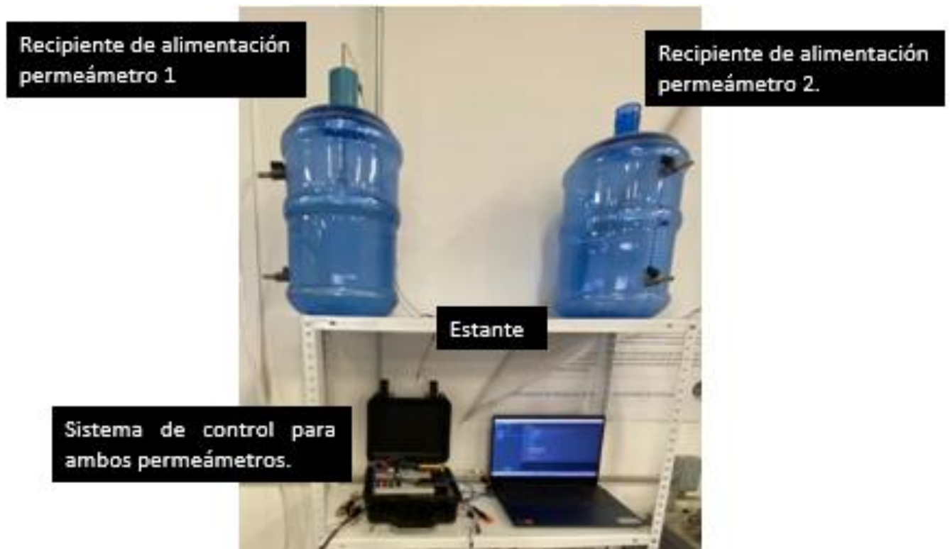
Figura 9. Disposición de bidones de alimentación y sistema de control en estante del equipo.
