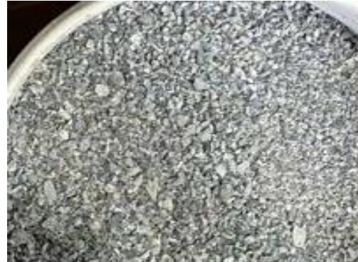
Figura 24. Resultado de chancado secundario mediante chancador de cono.
