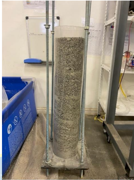
Figura 29. Proceso de llenado y compactación del material dentro del permeámetro.
