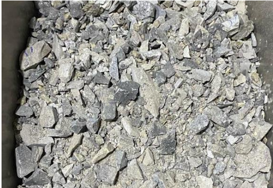
Figura 23. Resultado de chancado primario mediante chancador de mandíbula.
