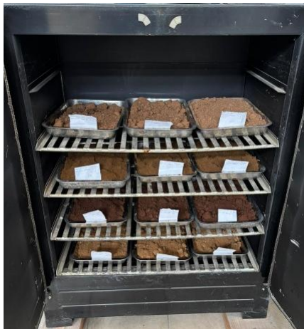
Figura 3.9 Muestras de suelos en horno para determinar su humedad
