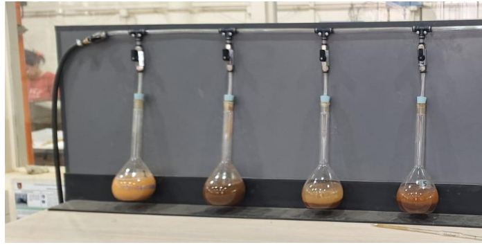
Figura 3.5 Proceso de extracción de aire de los picnómetros mediante bomba de vacío
