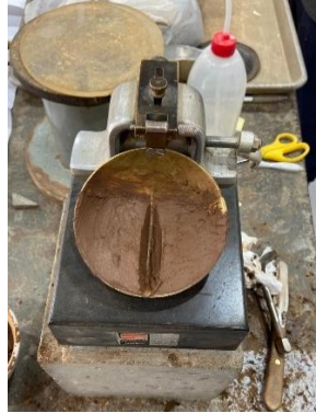
Figura 3.10 Ejecución del ensayo de Límite Líquido mediante el aparato de Casagrande
