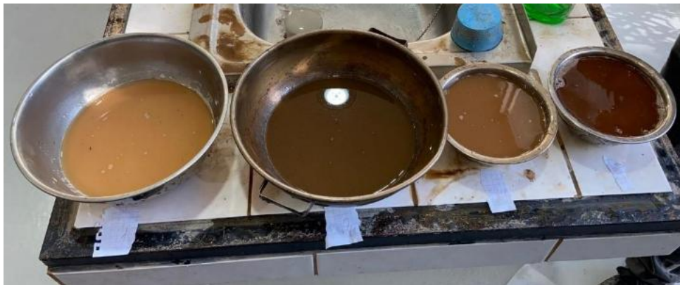
Figura 3.7 Proceso de lavado de suelos para determinar la cantidad de finos
