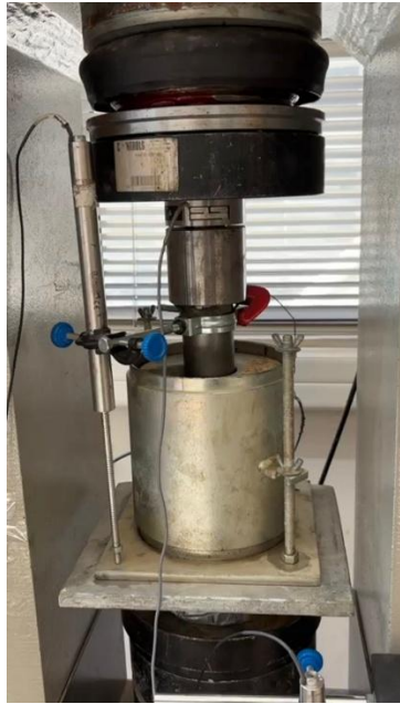
Figura 3.13 Ensayo de penetración a probetas de CBR
