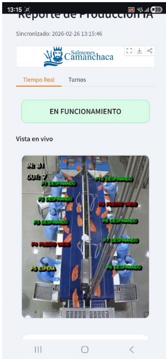
Fig. 3.6: Interfaz de monitoreo con estado EN FUNCIONAMIENTO (banner verde). Múltiples puestos activos con filetes en procesamiento. Fuente: elaboración propia.
