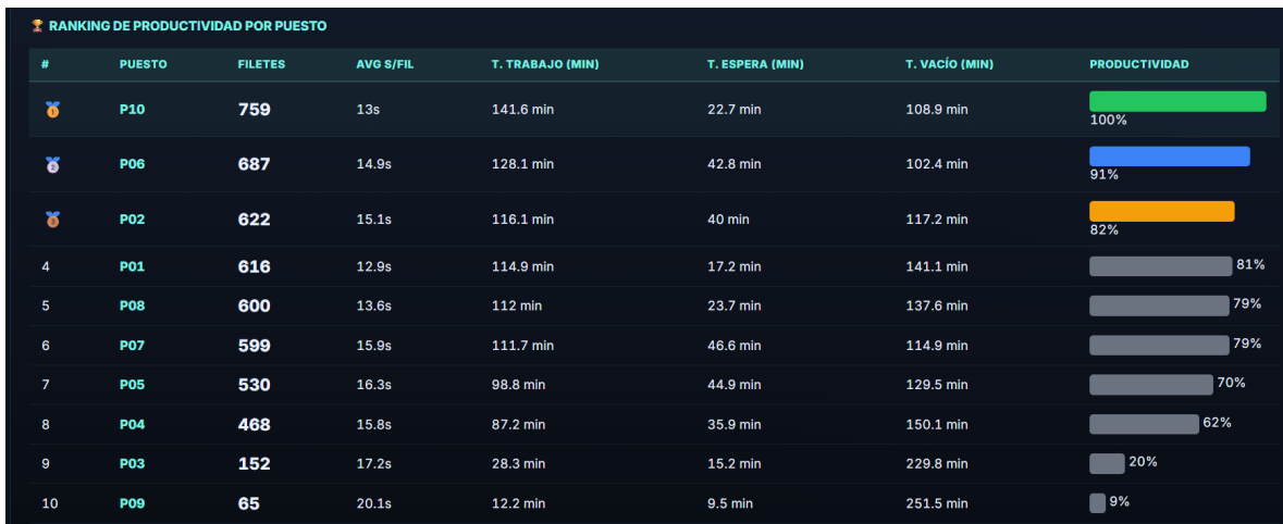
Fig. 3.9: Panel de productividad del reporte automático generado para el turno 2026-03-09 (13:29–18:39). Panel izquierdo: filetes procesados por puesto (P10 lideró con 759 filetes, seguido por P06 con 687 y P02 con 622; P09 registró sólo 65 filetes durante el turno). Panel derecho: distribución del tiempo por estado y puesto (verde = despinando, naranja = espera, rojo = vacío). Fuente: elaboración propia.
