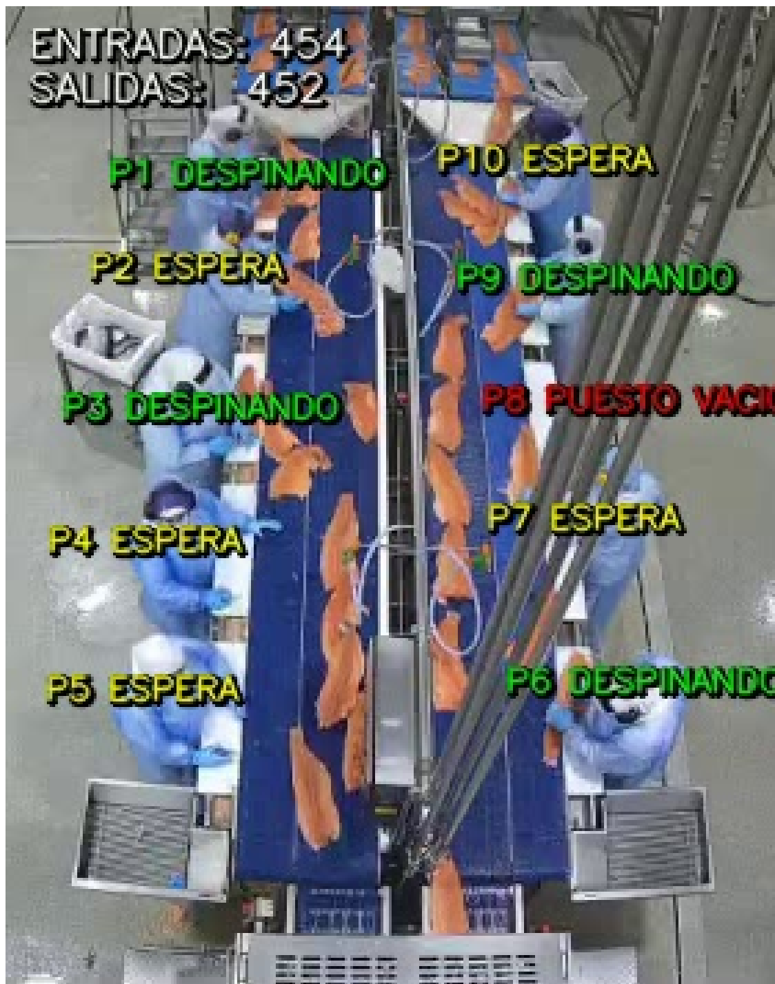
Fig. 3.4: Fotograma del pipeline en tiempo real durante un período de alta actividad productiva. Los recuadros azules corresponden a detecciones de operarios; los recuadros verdes a detecciones de filetes de salmón. La mayoría de los puestos se encuentra en estado DESPINANDO. Fuente: elaboración propia.
