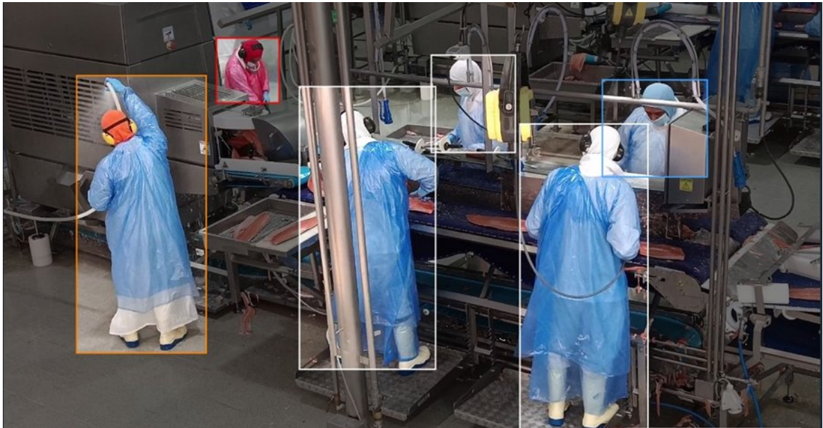
Fig. 3.12: Modelo de detección de EPP operando en condiciones reales en distintas zonas de la planta. Las bounding boxes de distintos colores identifican a los operarios según el color de su cofia y, por tanto, su rol: naranja (operador cofia naranja), rojo (personal de limpieza), blanco (operador cofia blanca) y azul (operador cofia azul). Fuente: elaboración propia.
