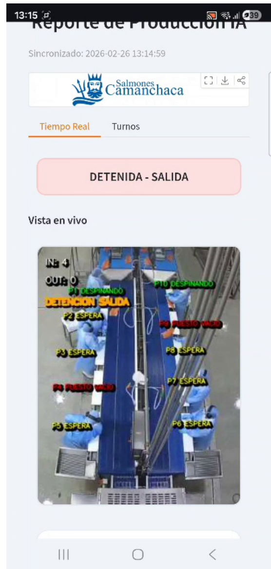
Fig. 3.7: Interfaz de monitoreo con estado DETENIDA – SALIDA (banner rojo). El sistema detecta y alerta automáticamente al superar los 40 segundos sin egreso de filetes. Fuente: elaboración propia.
