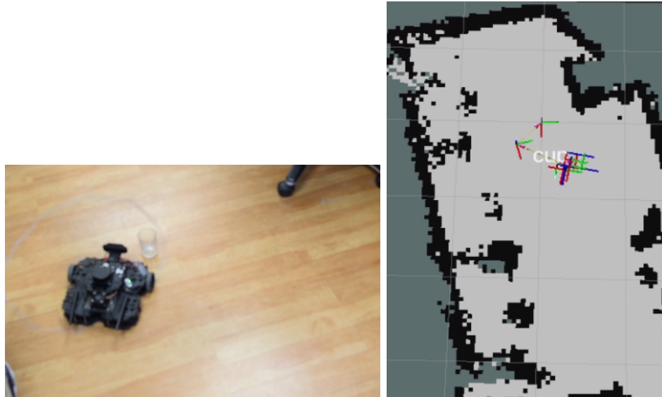
Figura 23: Comparación entre el entorno real y el mapa generado con el objeto detectado.
