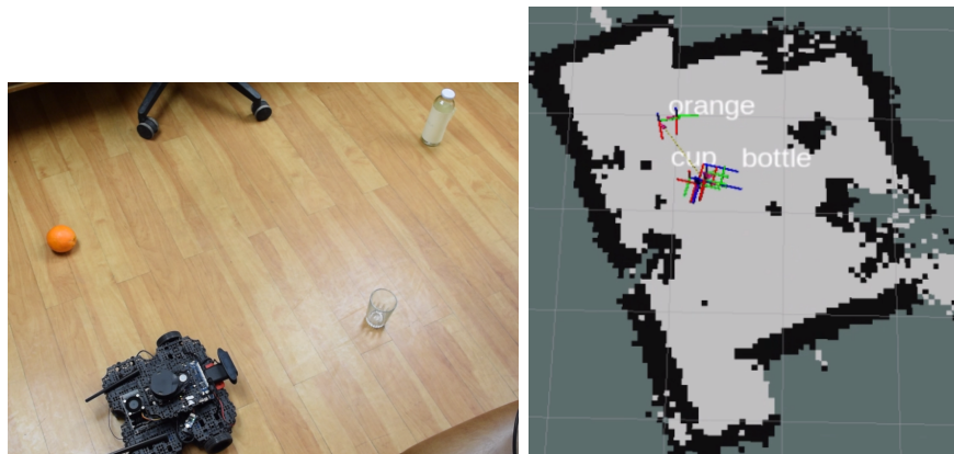
Figura 26: Comparación entre el entorno real y el mapa generado con los objetos detectados.
