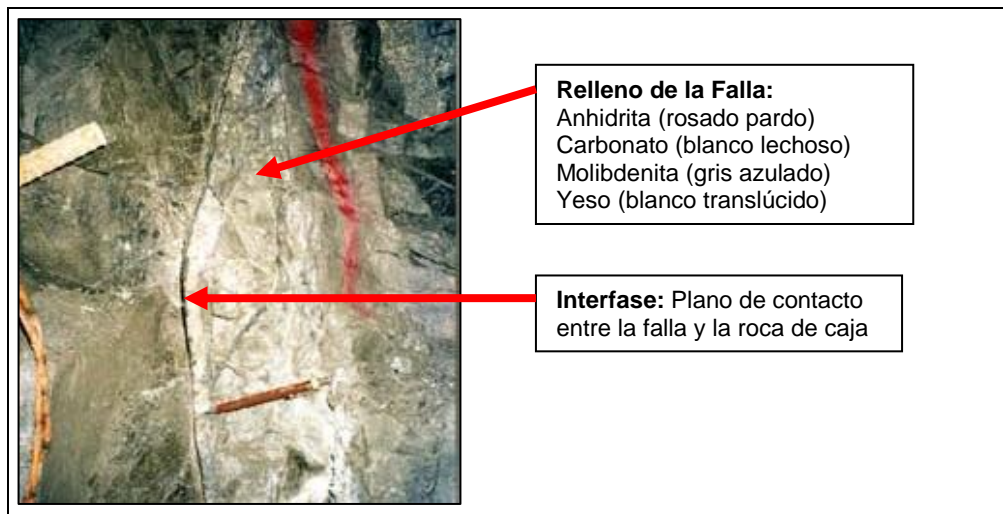
Figura 4.4: Material de relleno en el núcleo de falla. Seguel (2013).
