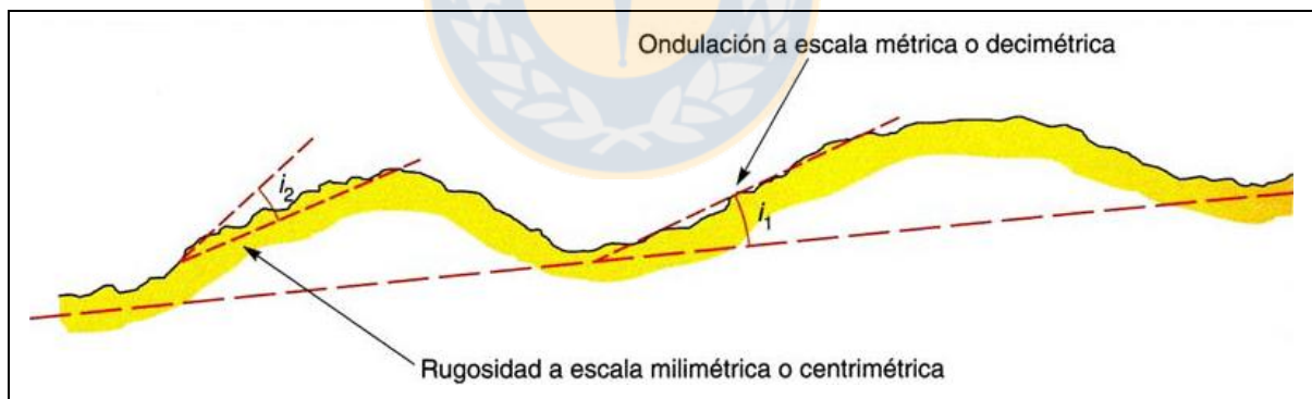
Figura 4.5: Ondulación y rugosidad de una superficie de discontinuidad. González de Vallejo et al. (2002).
