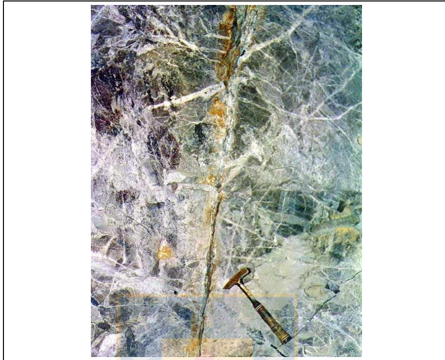
Figura 2.8: Vetilla Hidrotermal (HT) fallada en Nivel Sub6. Se observa una pátina rojiza (Óxido de Hierro) alrededor del plano fallado y vetillas TM (Cuarzo-anhidrita) desplazadas que evidencia su reciente movimiento. SGL (2003).
