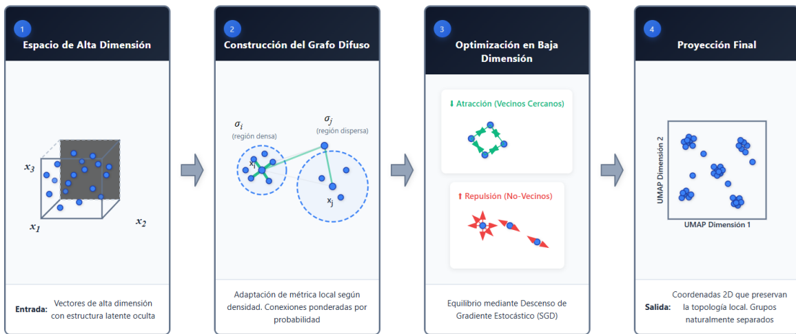
Figura 5: Representación esquemática de la proyección UMAP de 2048 a 32 dimensiones preservando estructura topológica.
