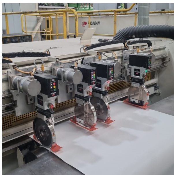
(a) PASABAN 5 ejecutando dos cortes sin extracción de polvo.
