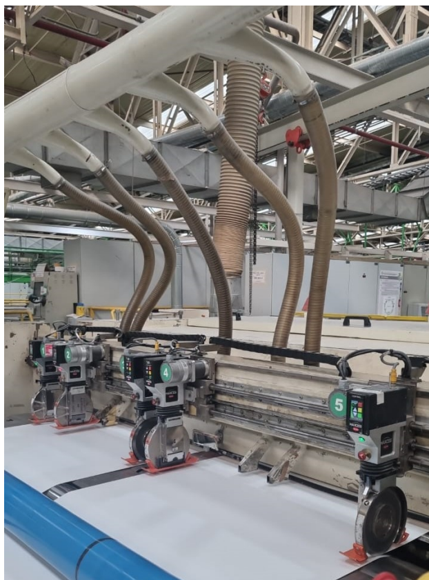
Figura A.1.6 PASABAN 1 ejecutando 4 cortes sin aspiración de polvo e.p.
