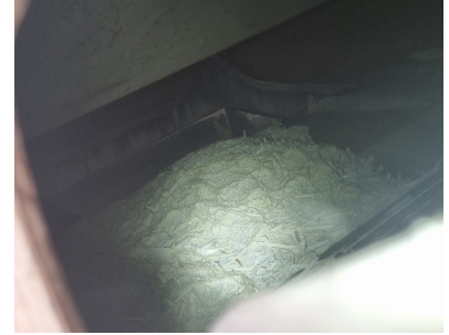
(c) Aglomeración de recorte y polvo posterior a la malla.
