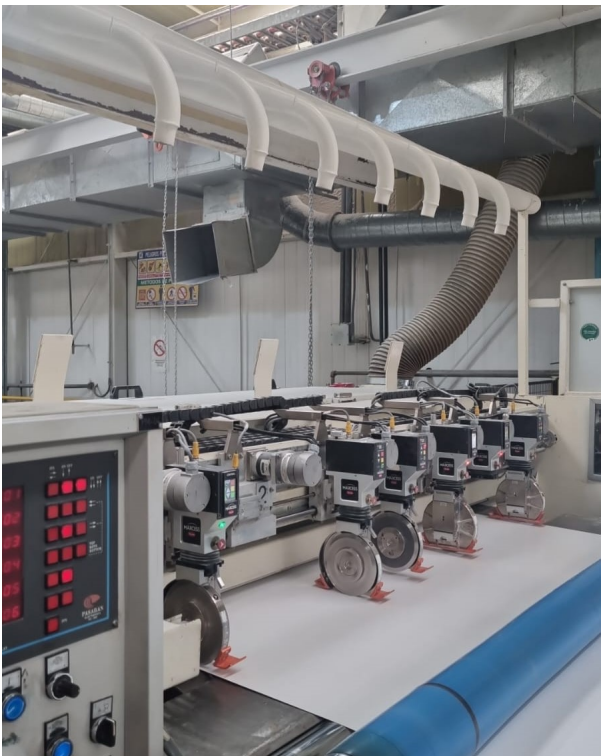
(a) PASABAN 3 ejecutando cuatro cortes sin aspiración de polvo.
