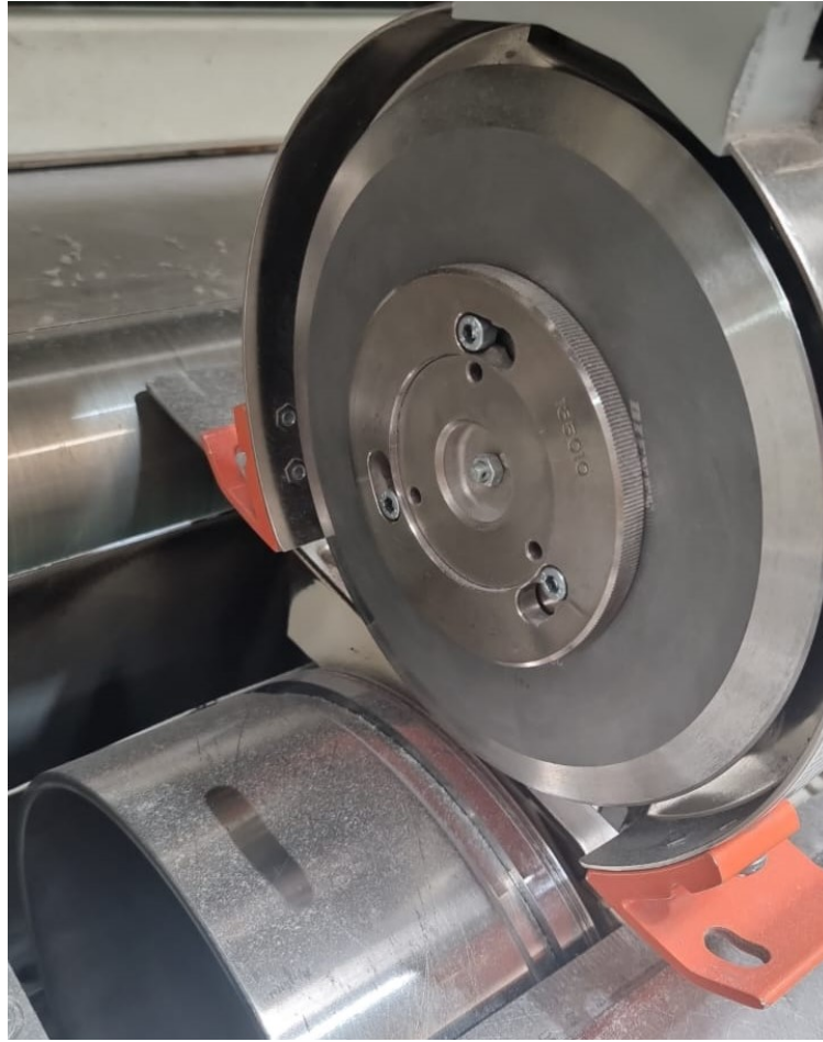
Figura A.1.27 Polvo en cuchilla cortadora PASABAN 7 e.p.
