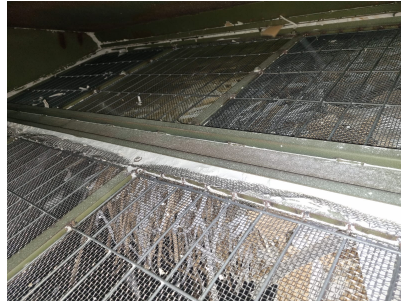
(b) Tapón de material en la malla asociado al deflector.
