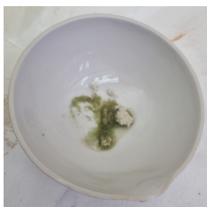
(a) Ácido clorhídrico: detección de estuco.
