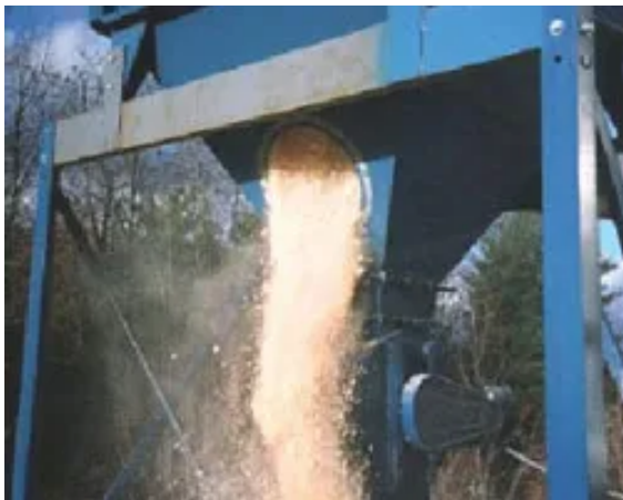
(a) Referencia de descarga gravitacional libre en tolva de colector de polvo.
