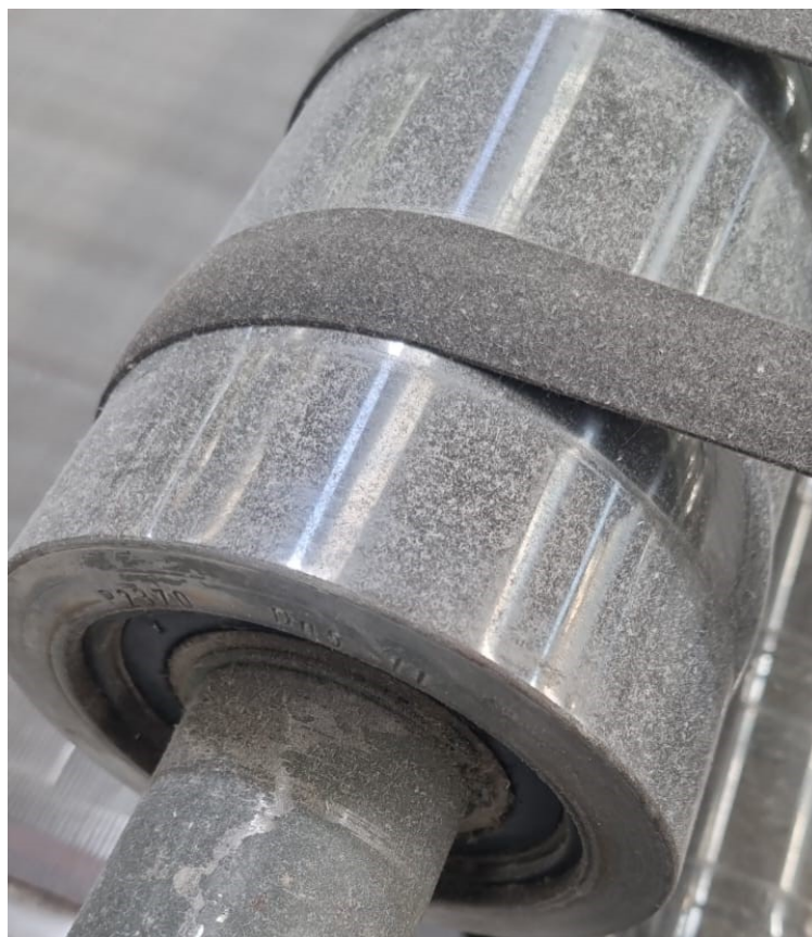
Figura A.1.28 Polvo en rodillos de la PASABAN7 e.p.
