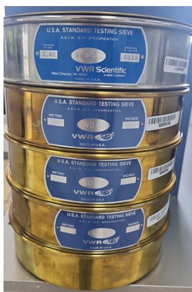
Figura 2.4.4 Columna de tamices utilizada para el análisis granulométrico.
