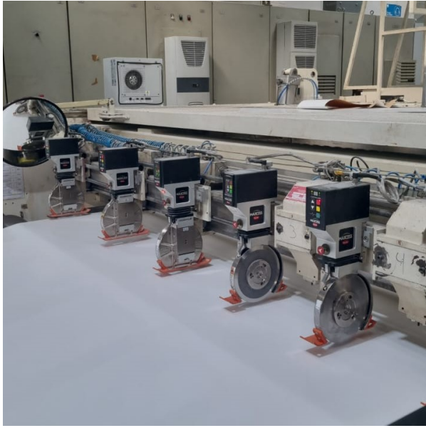
(a) Cuchillas cortadoras sin extracción de polvo en la Jagenberg.
