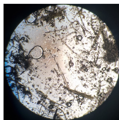
(c) Reactivo Lungo: celulosa y pulpa.
