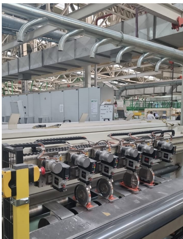
Figura A.1.26 PASABAN 7 ejecutando 2 cortes sin extracción de polvo e.p.
