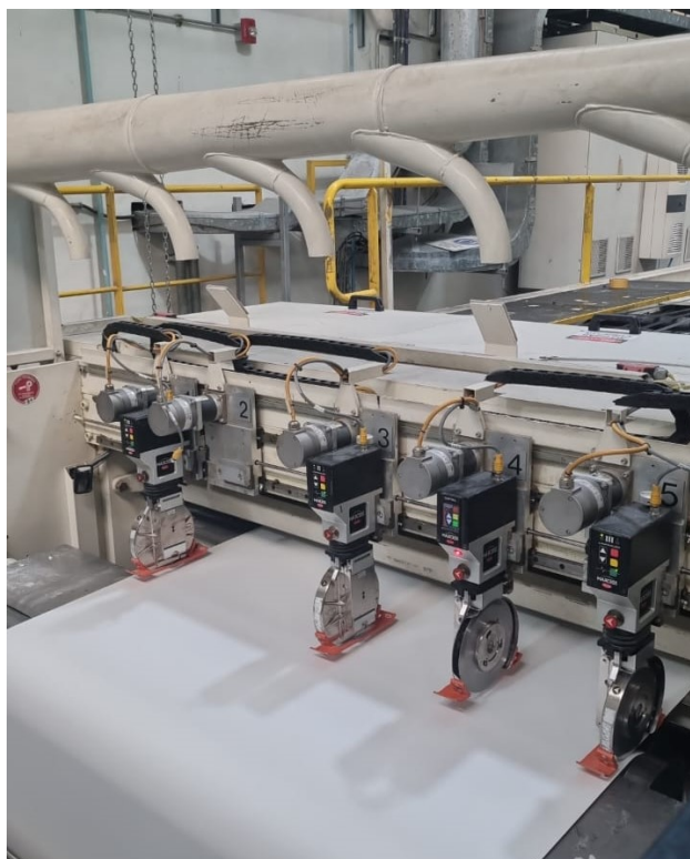
Figura A.1.22 PASABAN 6 ejecutando 2 cortes sin extracción de polvo e.p.
