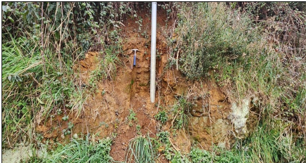
Figura 5.6: Afloramiento de Arenas Silíceas en la cancha Juventud Monte Redondo.
